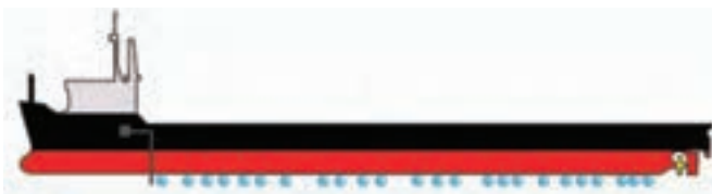
دمیدن هوا در زیر بدنه شناور به جهت کاهش مقاومت شناور
