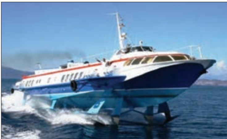
شناور هیدروفویل هنگام حرکت که از سطح آب بالا می‌آید
