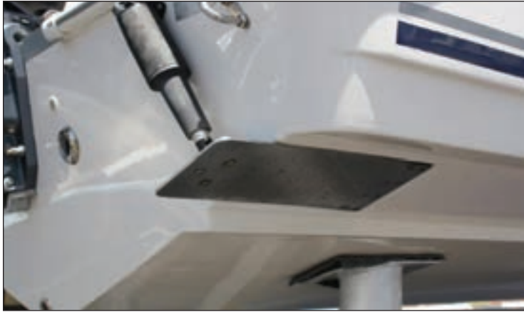
محل نصب تریم تب در بدنه شناور
