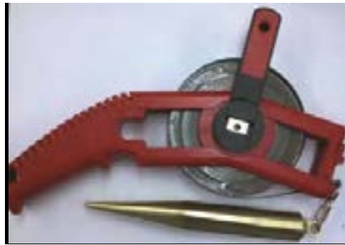
اندازه‌گیری سطح مخزن (ULLAGING FLOAT)
