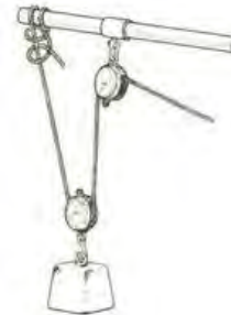
ترکیب بلوک با دو قرقره با قسمت ثابت بسته شده نزدیک به قرقره بالا
