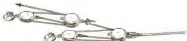
ترکیب بلوک و قرقره روی بلوک و قرقره
