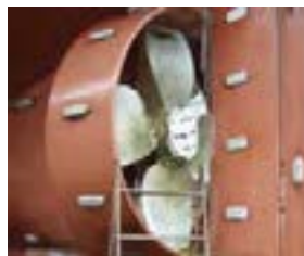
حفاظت قطبی از پروانه و مخزن آب توازن با استفاده از روی به عنوان فلز فدا شونده
