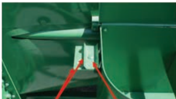
پیچ تنظیم کشش نخ‌ها صفحات کنترل کشش نخ
