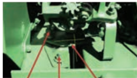
زاویه نود درجه پیچ تنظیم پایه تا کر فینگر سبک تنظیم
