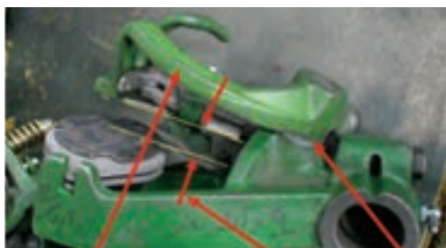
واشر این فاصله باید ۴ تا ۵ میلی‌متر باشد بازوی برش
