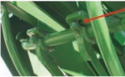
در شیار مسیر حرکتی خود پیچ کشویی برای تنظیم موقعی سوزن‌ها
