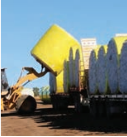
شکل ۴- جابه‌جا کردن عدل‌های گرد به وسیله دستگاه خاص
