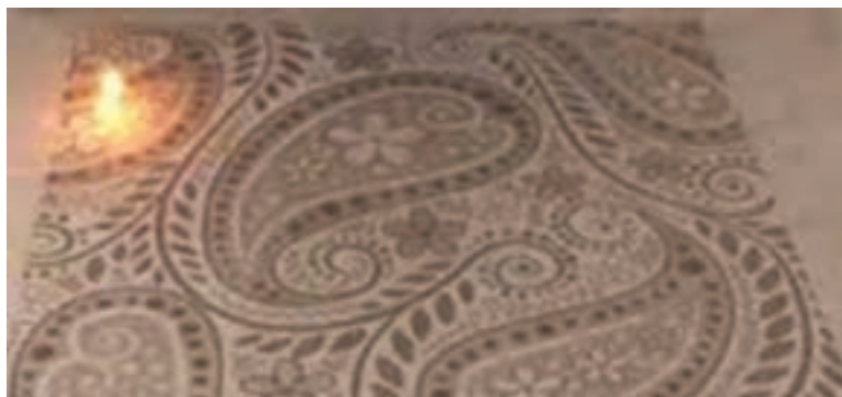
شکل ۱۰- ایجاد افکت و طرح روی پارچه پنبه‌ای (کاربرد زینتی، پرده، رومبلی و پارچه خاص) با لیزر
