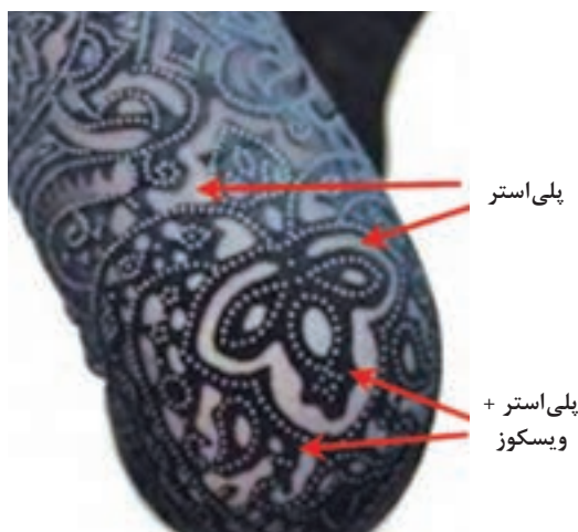
شکل ۴- چاپ سوخت روی پارچه با نخ مغزی دار
