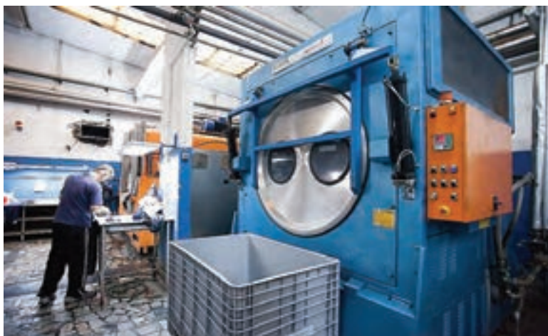
شکل ۲- یک نمونه ماشین سنگ‌شویی جین
