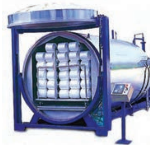
شکل ۳- ماشین اتوکلاو جهت تثبیت حرارتی نخ
