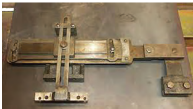
شکل ۸- خط کش راهنما برای مخروط تراشی
