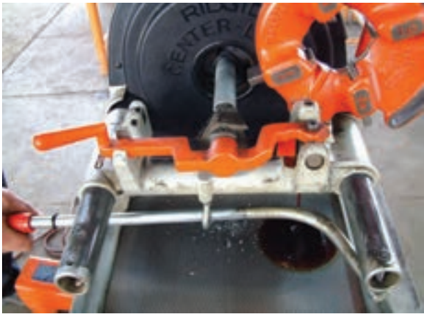
شکل ۱۳۲-۴ عمل بُرقوکاری
