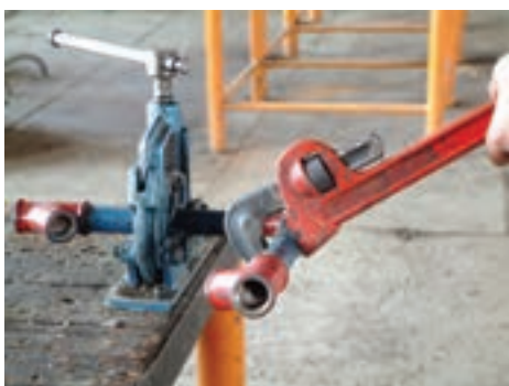
شکل ۵-۱۴۰- بستن ضلع دوم مدار مثلث شکل
