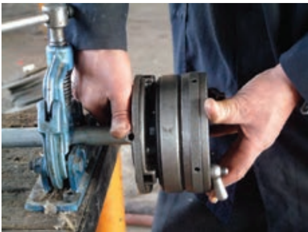
شکل ۴-۷۱- باز کردن سہ نظام حدیدہ
