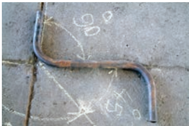
شکل ۳-۴۱- عدم دویدگی لوله‌ی دو خم
