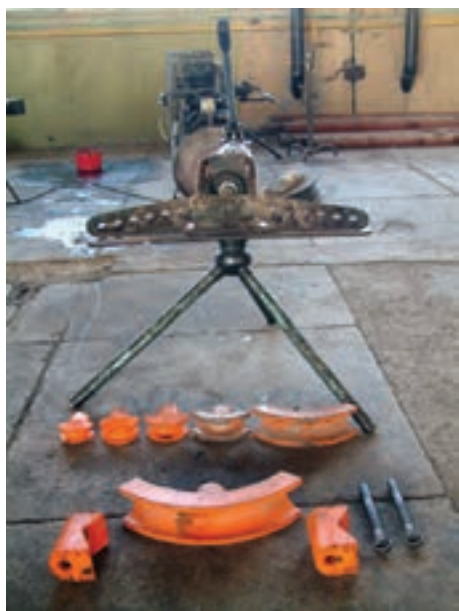
شکل ۱۳-۳- اجزای خم کن هیدرولیکی
