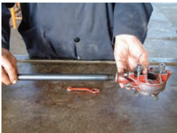
شکل ۴-۲۵ اتصال دسته‌ی حدیده به بدنه‌ی حدیده
