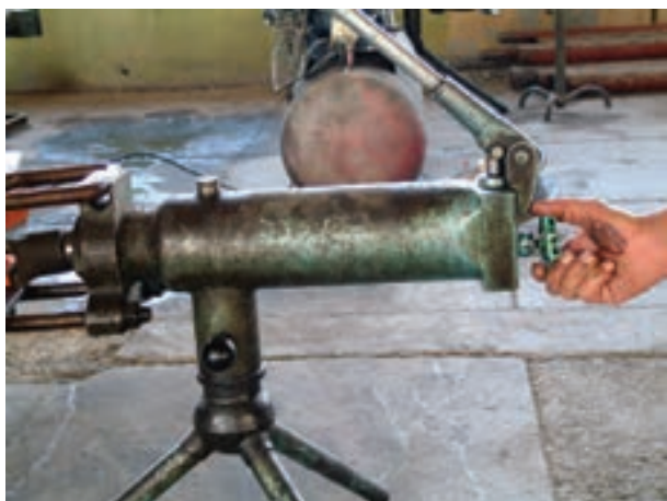
شکل ۳-۲۳- بستن شیر قطع و وصل
