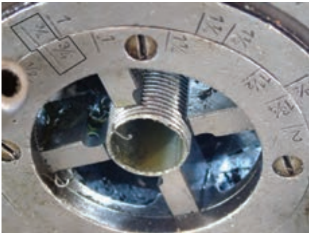
شکل ۴-۶۹- حد صحیح حدیدہ کردن لولہ ی \frac{3}{4}
