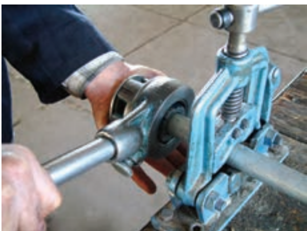
شکل ۴-۴۷- شروع دنده کردن لوله
