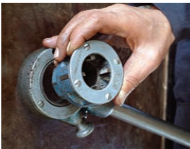
شکل ۴-۴۴- خارج کردن پارچه از بدنه‌ی حديد
