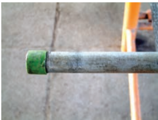
شکل ۴-۱۶ اتصال بوشن پلاستیکی به سردنده‌ی لوله
