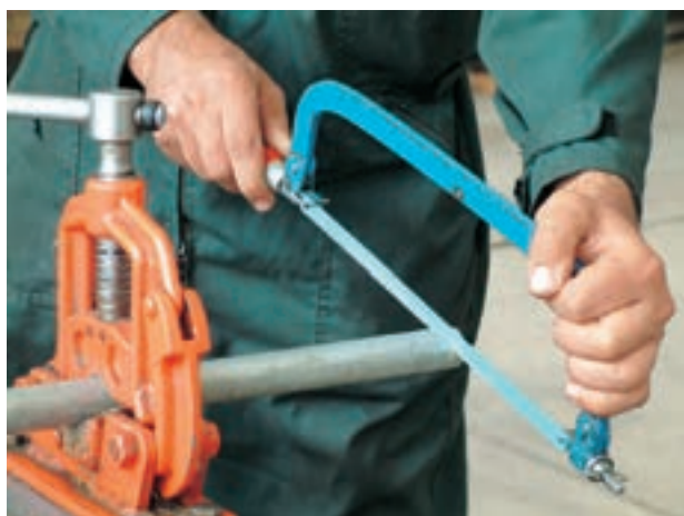
شکل ۵۰-۱- عدم رعایت فاصله‌ی مناسب از لب گیره
