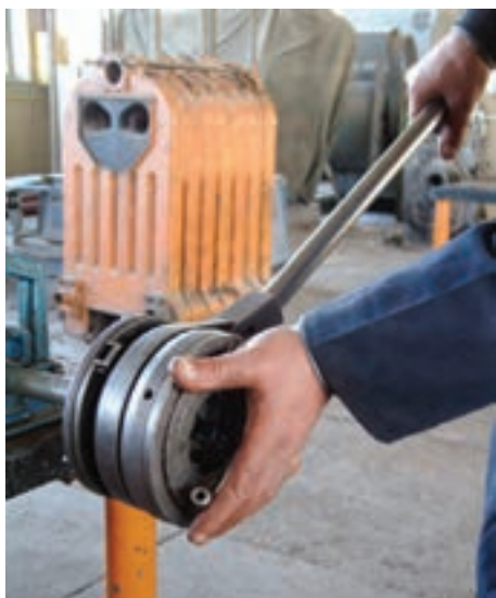
شکل ۴-۶۶- درگیر کردن حدیده با سر لوله
