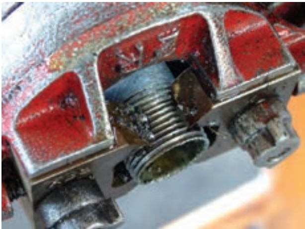
شکل ۴-۳۶- عبور دو دندانه از انتهای پارچه
