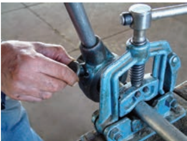
شکل ۴-۴۶- قرار دادن ضامن در جهت حدیده کردن
