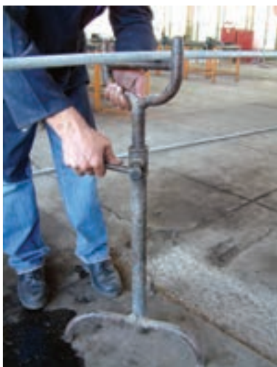
شکل ۴-۷۶- طرز تنظيم خرك به زير لوله
