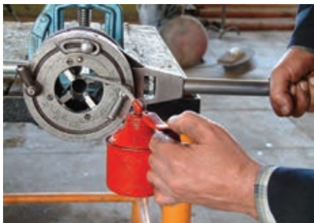
شکل ۴-۶۸- عمل روغن کاری در حین حدیده کاری
