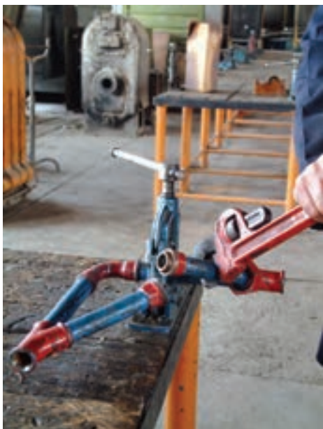
شکل ۵-۱۴۱- بستن یکی از قطعات به سهراهی
