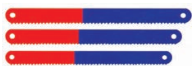
شکل ۹-۱ جزئیات دندانه‌های تیغه ارّه
