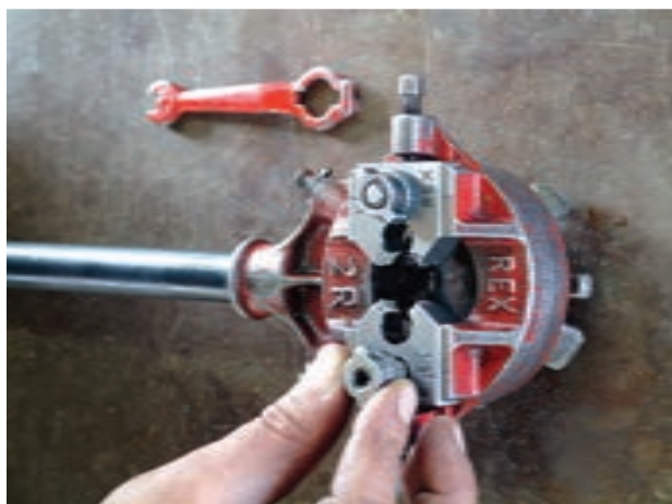
شکل ۴-۲۷- بستن مهره‌ها بر روی پارچه‌های حدیده
