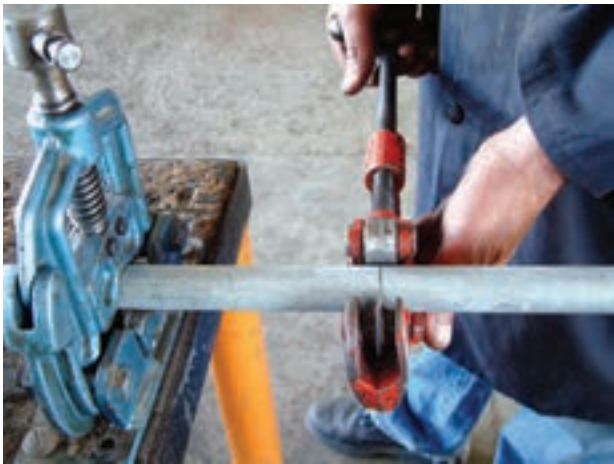
شکل ۱-۶۲- سفت کردن دسته‌ی لوله‌بر به اندازه‌ی لازم
