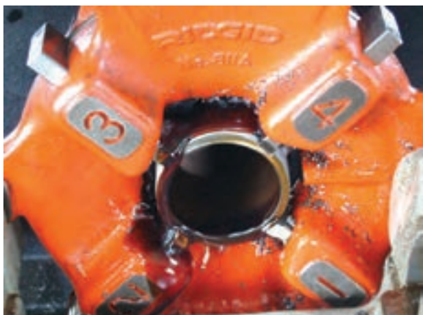
شکل ۴-۹۵- عمل حدیده‌کاری به وسیله حدیده‌ی ماشینی
