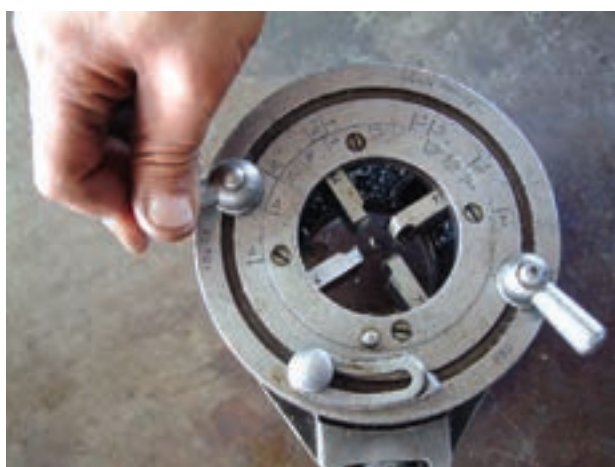
شکل ۴-۶۲- سفت کردن مهره‌های ثابت‌کننده‌ی رینگ متحرک
