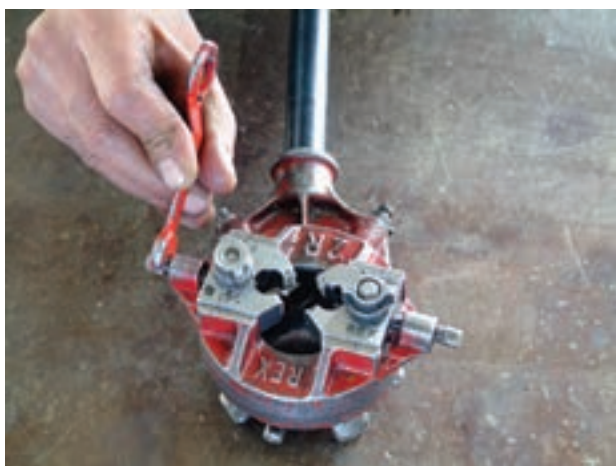
شکل ۴-۲۹- تنظیم کردن حدیده به وسیله‌ی آچار حدیده
