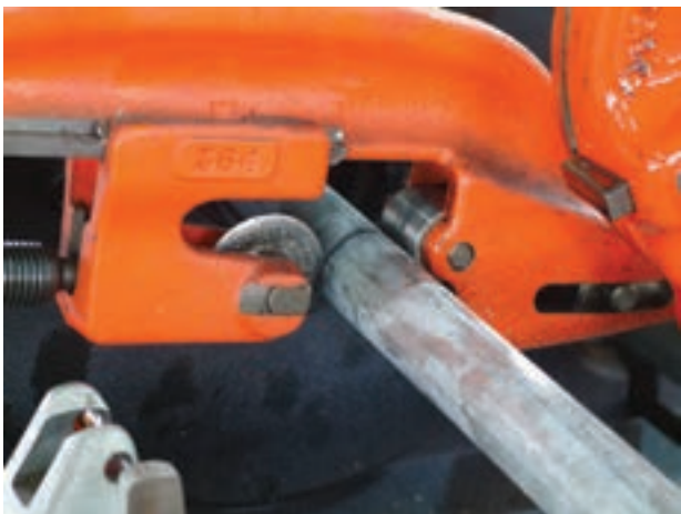
شکل ۴-۱۳۷- بریدن لوله به وسیله ی لوله بُر
