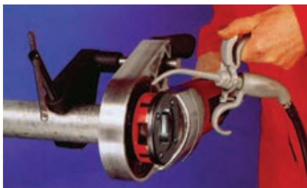
شکل ۴-۱۰۸- استفاده از روغن‌دان در جریان لوله‌کشی
