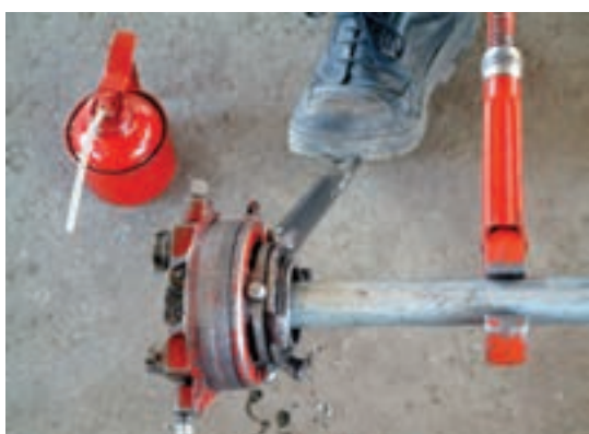
شکل ۱۲۳-۵- عمل باز کردن سردنده از پارچه‌های حدیده
