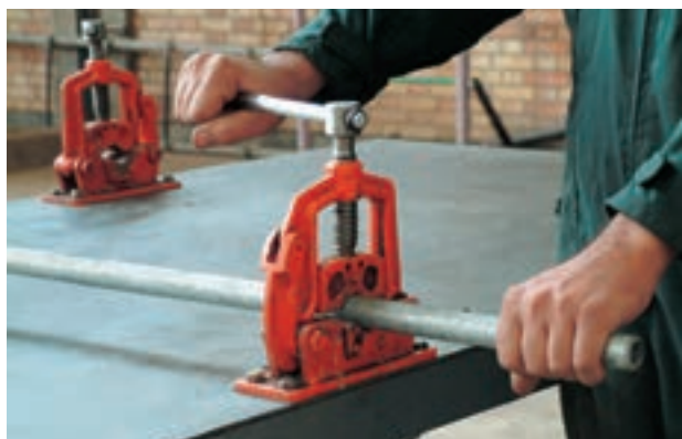
شکل ۳-۵۳ باز کردن شاخه‌ی لوله از گیره‌ی لوله
