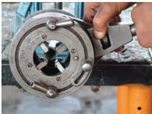
شکل ۴-۵۶- قرار دادن ضامن در حالت F
