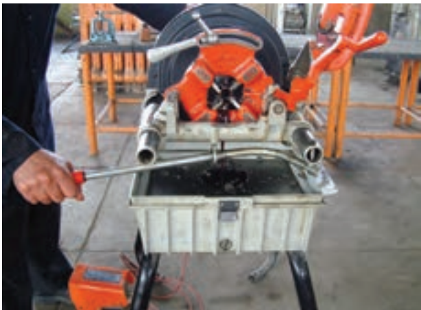
شکل ۱۳۳-۴ عمل حدیده کاری لوله
