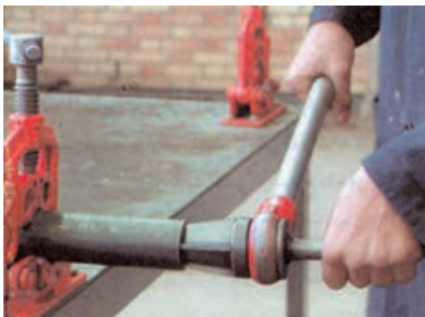
شکل ۴-۱۱۳- عمل برقوکاری
