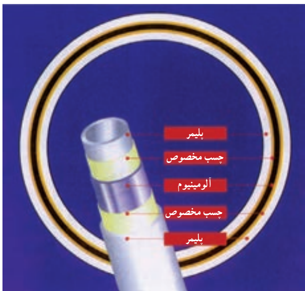
شکل ۵-۲۰ ساختار لوله‌ی پلی اتیلن پنج لایه
