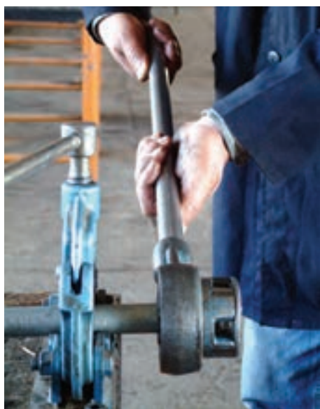
شکل ۵۰- باز کردن حدیده از لوله
