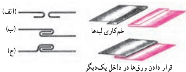
شکل ۴-۲- مراحل مختلف اتصال پیچک
