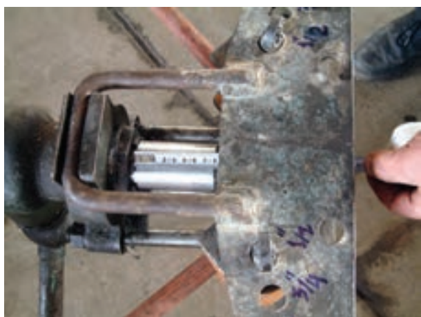
شکل ۳-۲۷- اندازه‌گیری طول پیستون خارج شده از سیلندر
