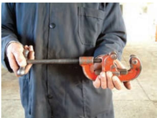
شکل ۱-۵۴ - باز کردن دهانه‌ی لوله‌بر
