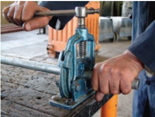
شکل ۳۵-۱- بستن لوله به گیره برای ارّه کاری
