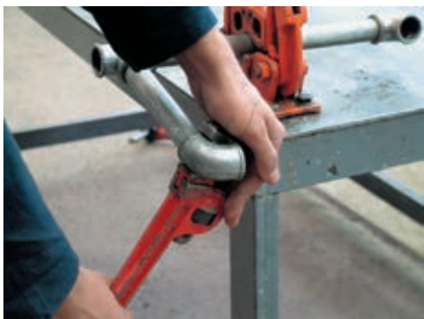
شکل ۵-۱۰۵- روش غلط سفت کردن مدار
