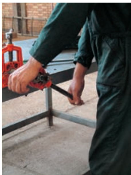
شكل ۴-۱۱۲- حديدكاري متناسب با قطر لوله
