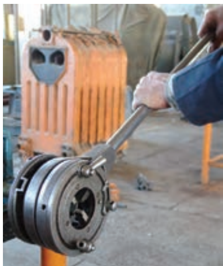
شکل ۴-۶۷- دنده کردن لوله
