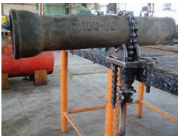
شکل ۱-۳۴- بستن لوله به گیره‌ی زنجیری
