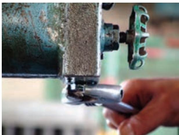
شکل ۱۴-۳- باز کردن درپوش تخلیه ی روغن
