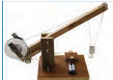
الف- ساز و کار حرکتی جرفقیل اسباب بازی
