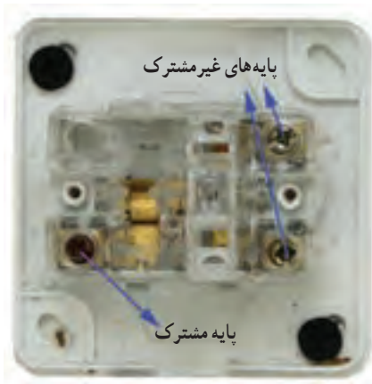
شکل ۱۹-۵- نمای داخلی یک نمونه کلید تبدیل
