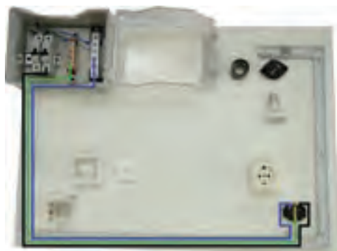
شکل ۵-۱۰- انجام سیم‌کشی پریز ۱
