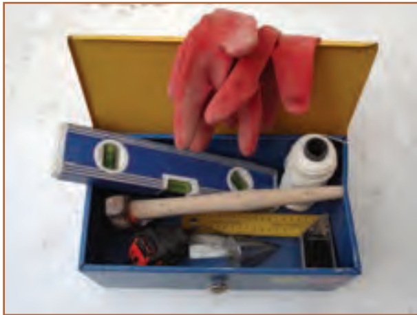
شکل ۱۰-۷- برخی از ابزار مورد نیاز دیوار چینی
