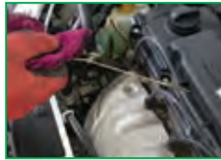
ب- میله اندازه‌گیر روغن موتور را بیرون بکشید.
