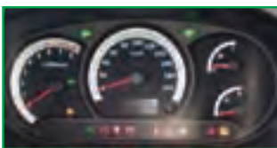
شکل ۸-۱۴- چراغ‌های هشداردهنده خودرو
