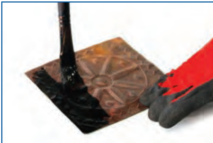
شکل ۱۰-۱۰- آغشته کردن سطح پلاک مسی به قیر
