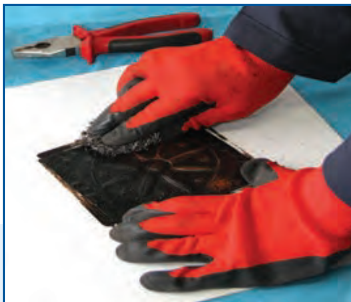
شکل ۱۱-۱۰- ساب زدن سطح پلاک مسی
