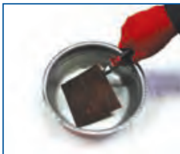
شکل ۹-۱- سرد کردن پلاک مسی با آب
