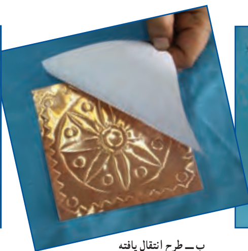
شکل ۴-۱- نحوه انتقال طرح روی ورق مسی
