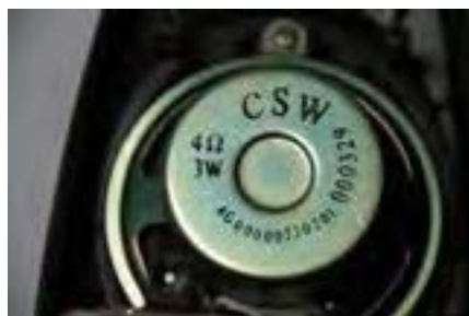
شکل ۹- توان بلندگو و آمپدانس
