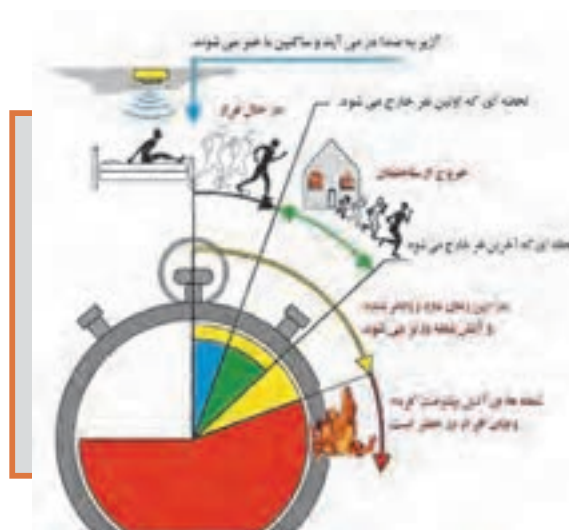
شکل ۳۰- مدیریت زمان هنگام اعلام حریق
