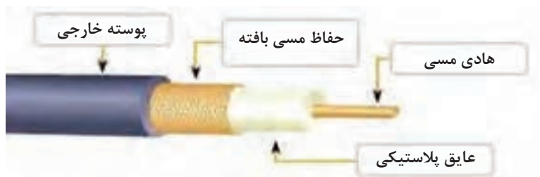
شکل ۳- اجزای کابل کواکسیال
