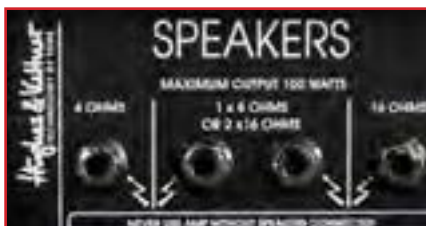
شکل ۲۰- آمپدانس خروجی بلندگو
