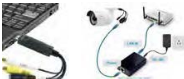
شکل ۲۸ - اتصال دوربین IP
