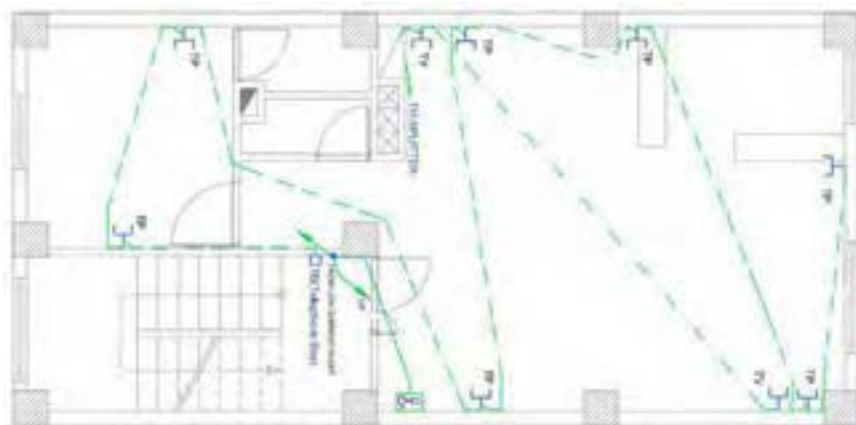
شکل ۱۰ - نقشه سیم‌کشی پریز تلفن و پریز آنتن
