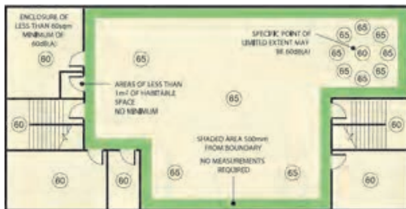
شکل ۶ - شدت صوت هشدار دهنده در فضاهای مختلف
