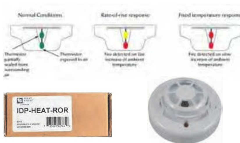
شکل ۴۳ - برچسب روی جعبه دتکتور سمت چپ و نحوه عملکرد دتکتور
