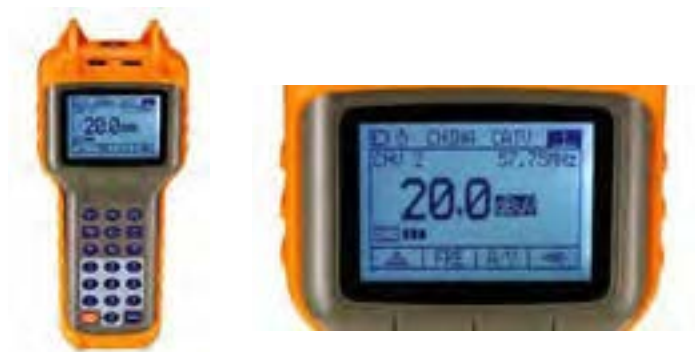
شکل ۲۴- اندازه‌گیری سیگنال خروجی آنتن توسط سیگنال سنج
