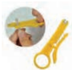
شکل ۶- روکش‌بردار کابل
