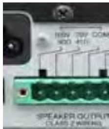
شکل ۲۳- ترمینال ولتاژ بالا
