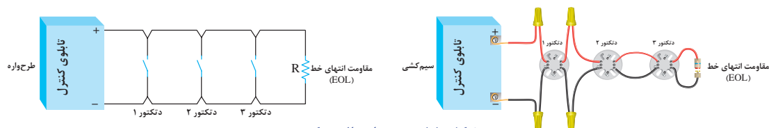
شکل ۵۵- نحوه اتصال دکتور
