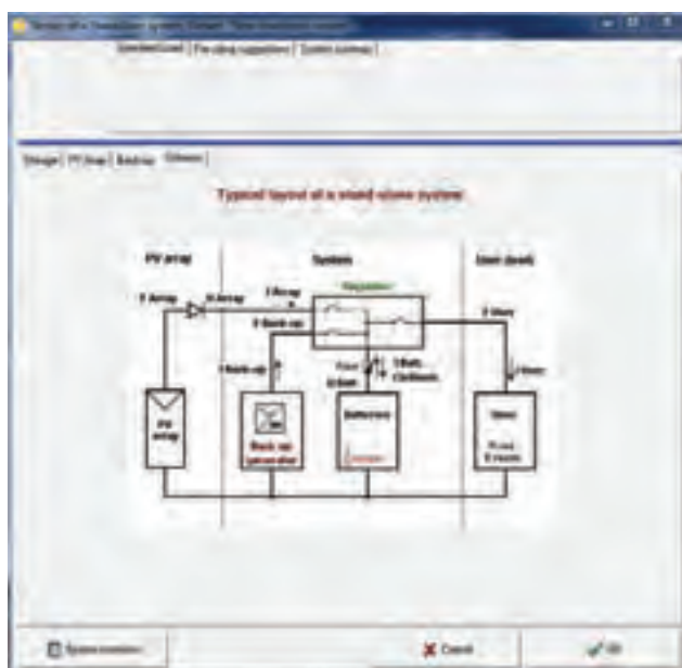
شکل ۳۹- شمای فنی پیشنهادی سامانه جدا از شبکه
