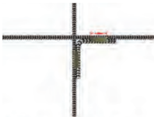
نحوه جوشکاری میلگردها در یک تقاطع چهارراه
