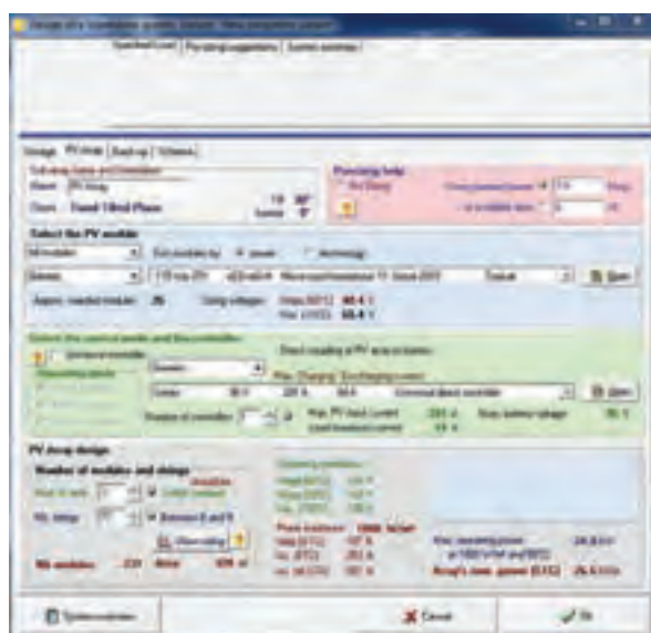
شکل ۳۸- مقادیر مدول PV، کنترل شارژ
