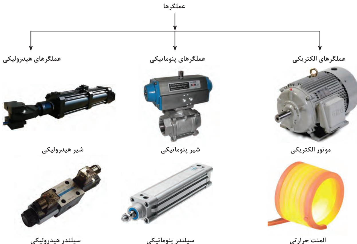
شکل ۲۶-۵- انواع محرک‌ها در سیستم‌های کنترلی
