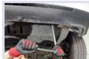
۳- سینی زیر موتور در صورت وجود باز شود.
