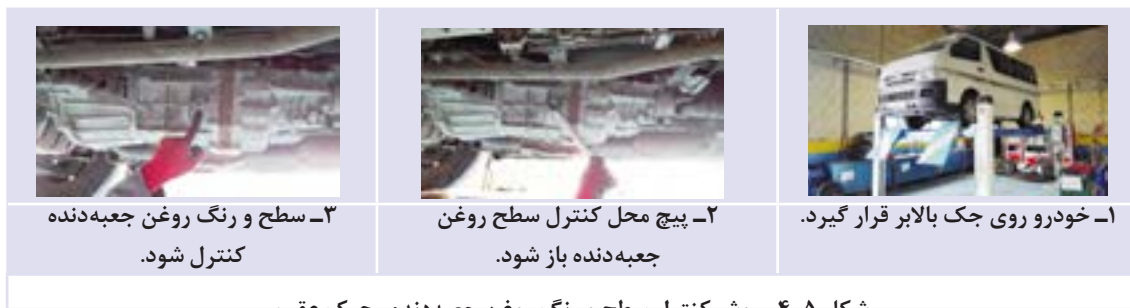
شکل ۴-۵- روش کنترل سطح و رنگ روغن جعبه‌دنده محرک عقب
