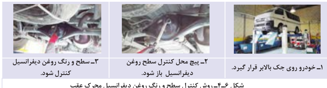
شکل ۴-۶- روش کنترل سطح و رنگ روغن دیفرانسیل محرک عقب
