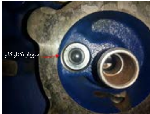
شکل ۳-۱۶- سوپاپ کنارگذر تعبیه شده در مدار روغن کاری موتور
