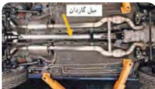
شکل ۳۲-۶- میل گاردان بارگذاری پیچشی را برای انتقال گشتاور تحمل می کند.
