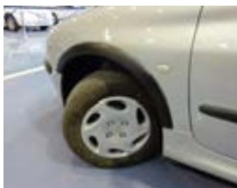
۶- فرمان کاملاً به سمت چپ و سپس کاملاً به سمت راست چرخانده شود. ( حداقل ۱۰ بار )
