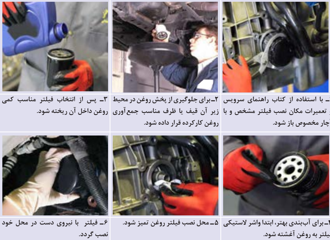
شکل ۱۷-۳- مراحل تعویض فیلتر روغن
