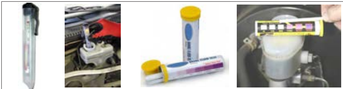
شکل ۶-۷- تست کیفیت مایع هیدرولیک ترمز
