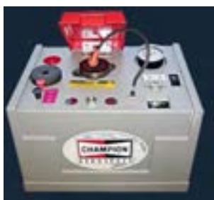
شکل ۲۴-۸- دستگاه شمع پاک‌کن با قابلیت تست شمع
