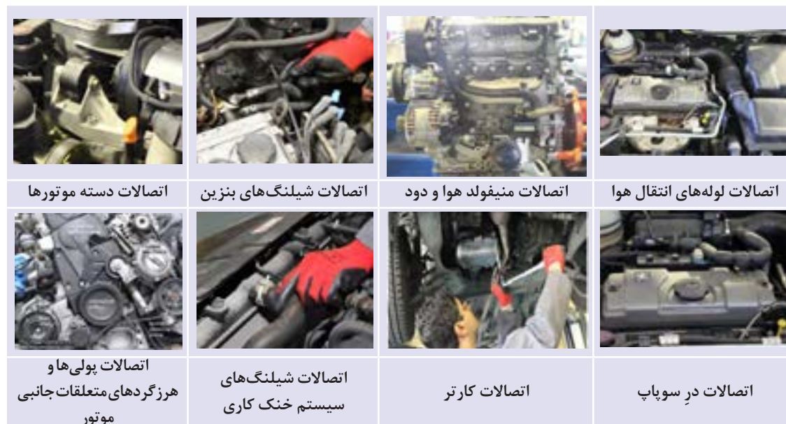
شکل ۱-۲۳ - بخش‌های مختلف سیستم مولد قدرت برای آچارکشی
