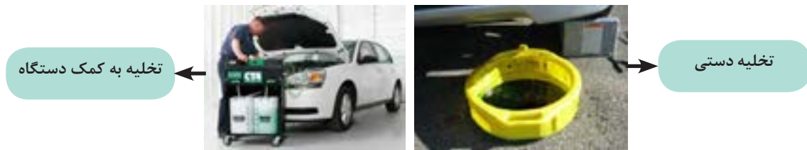
شکل ۲۸-۷- روش‌های تخلیه مایع خنک کننده
