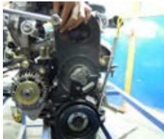
۲- تسمه تجهیزات جانبی باز شود.
