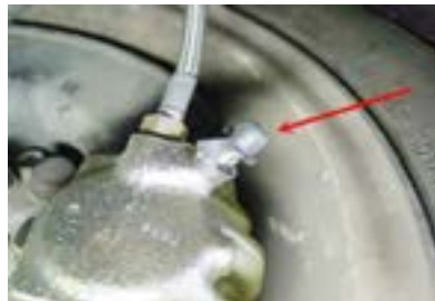
شکل ۱۰-۶- تخلیه مایع هیدرولیک ترمز به صورت دستی
