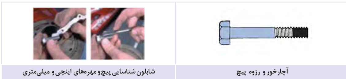
شکل ۱۳-۱ - شناسایی رزوه پیچ
