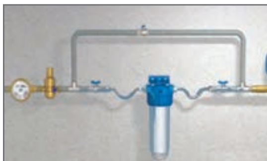
شکل ۶- روش نصب سختی گیر پلی فسفات
