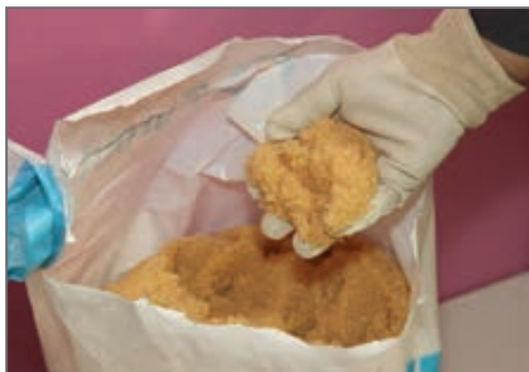
شکل ۲۰- دانه‌های رزین پرولایت C۱۰۰E کیسه ۲۵ لیتری
