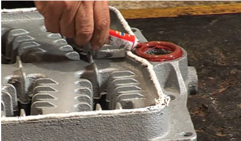
شکل ۲۰- استفاده از اورینگ به جای بوش
