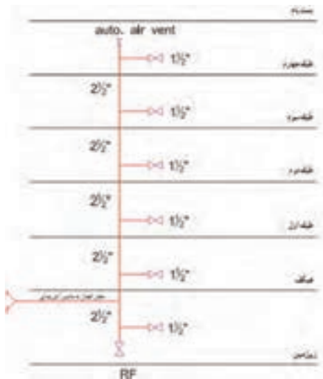
شکل ۲۱- رایزر دیاگرام لوله کشی آتش نشانی خشک
