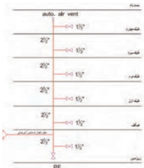
شکل ۲۱- رایزر دیاگرام لوله کشی آتش نشانی خشک
