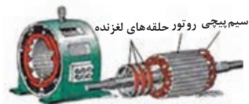
شکل ۴ - الکترو موتور با روتور سیم پیچی
