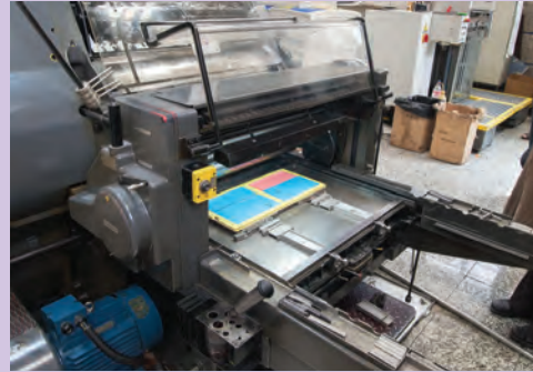
تصویر ۱۰ نصب قالب روی ماشین لترپرس
