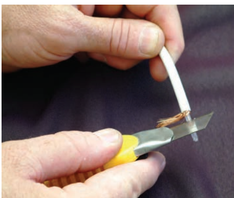
شکل ۱-۶۱- در بریدن کابل باید دقت شود.
