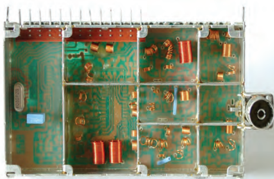
شکل ۲-۴۳- سیم‌پیچ‌های داخل تیونر
