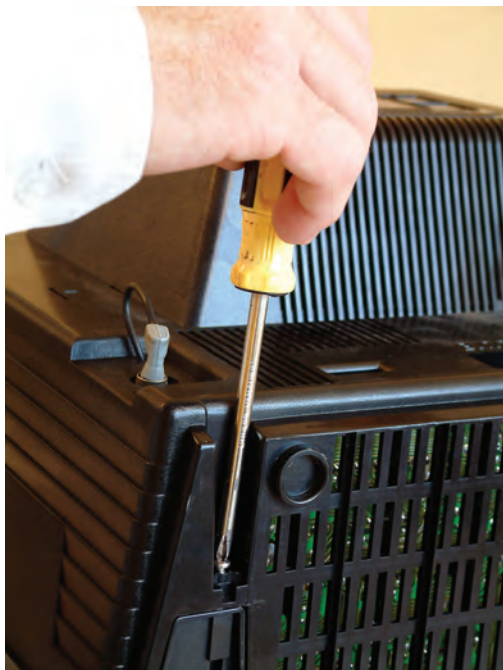
شکل ۲-۴۲- نحوه‌ی باز کردن قاب پشت تلویزیون
