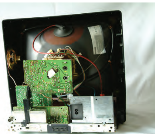
شکل ۲-۴۴- تلویزیون بدون قاب پشت
