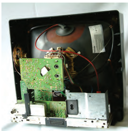
شکل ۱۹-۲- تلویزیون بدون قاب پشت
