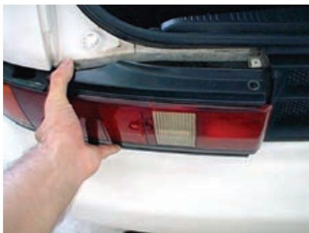
شکل ۱-۵۸- جدا کردن چراغ عقب از بدنه‌ی خودرو
