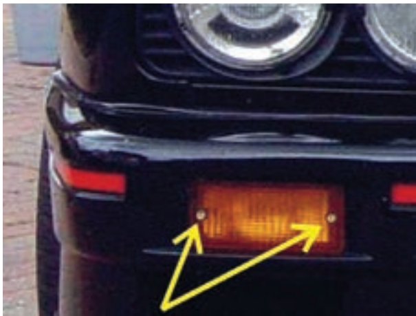
شکل ۱-۵۰ پیچ‌های اتصال تلق چراغ راهنما
