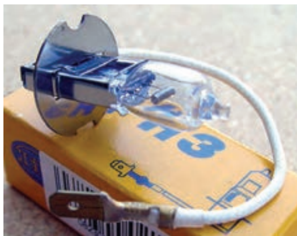
شکل ۱-۳۱- لامپ مورد استفاده در چراغ‌های مه‌شکن، نورافکن‌ها
