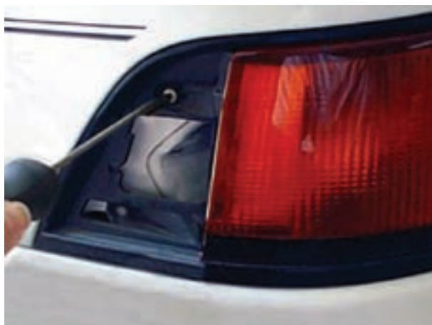
شکل ۱-۵۶- باز کردن پیچ‌های قاب چراغ
