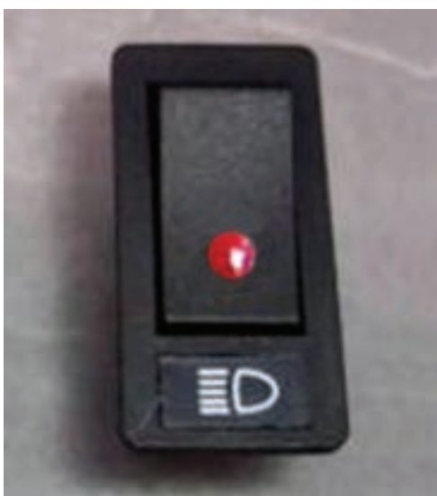
شکل ۸۱-۱- سوئیچ چراغ‌های جانبی (پارک)
