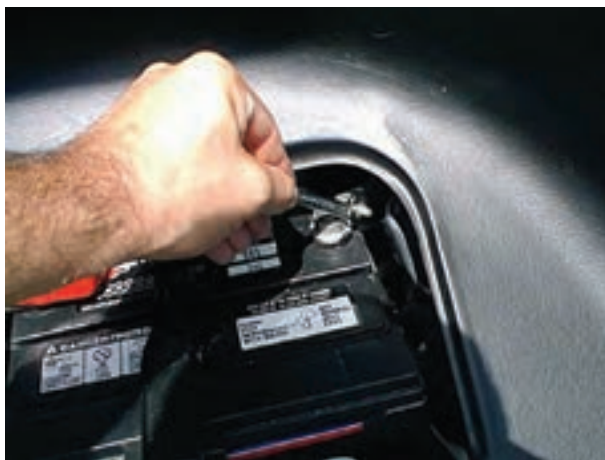
شکل ۱-۵۲ باز کردن بست ترمینال منفی باتری
