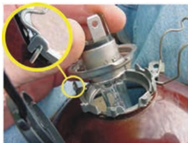
شکل ۱-۴۳- نحوه‌ی ثابت شدن لامپ درون کاسه‌ی چراغ
