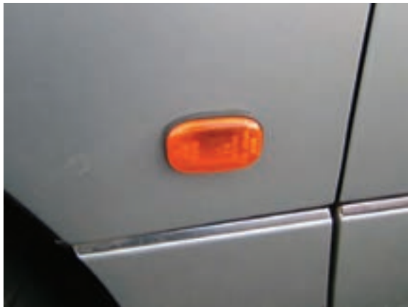
شکل ۱-۶۵- چراغ راهنمای بغل در یک نوع خودرو
