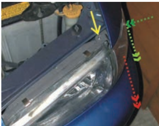
شکل ۱-۳۸- نحوه‌ی جداکردن چراغ جانبی روشنایی
