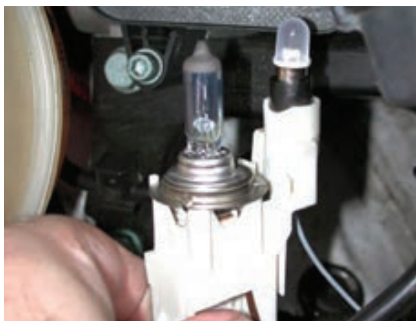
شکل ۱-۴۹ - پایه‌ی مشترک لامپ‌های چراغ روشنایی و پارک
