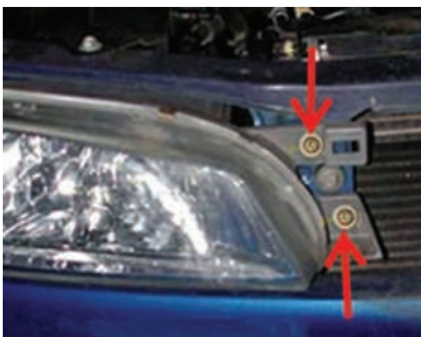
شکل ۱-۴۰- پیچ‌های نگه‌دارنده‌ی چراغ‌های بزرگ جلو
