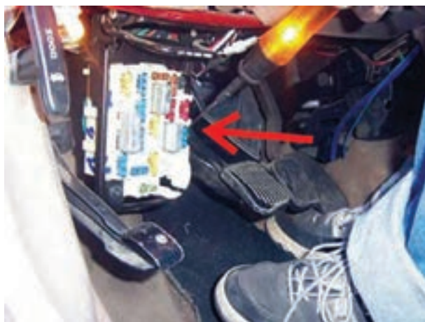
شکل ۱۲۰-۱- آزمایش جعبه‌ی فیوز با چراغ آزمایش
