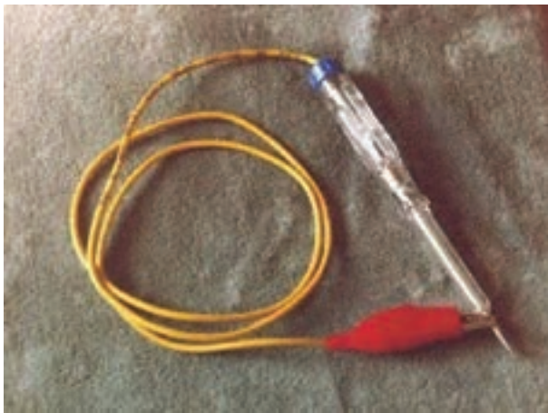
شکل ۱-۱۲۱- چراغ آزمایش بدون باتری
