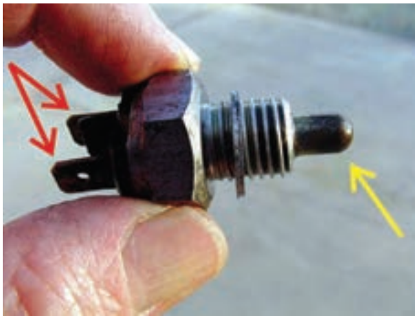
شکل ۱۰۴- پلانجر و ترمینال‌های سوئیچ دنده عقب
