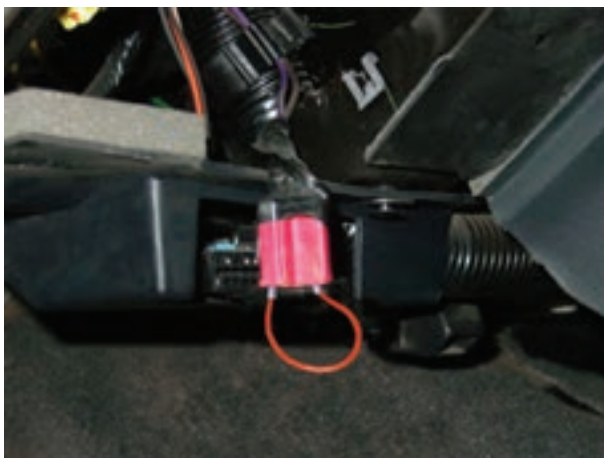
شکل ۱۲۸-۱- خارج نمودن اتوماتیک راهنما از محل خود در داخل پانل جلوی راننده
