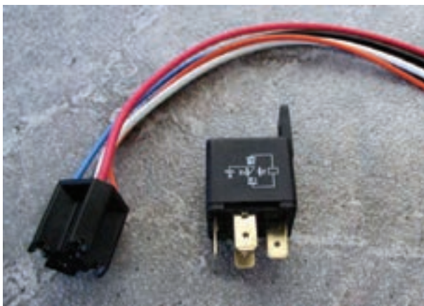
شکل ۱-۱۲۲- یک نوع آفتامات مدار الکتریکی خودرو
