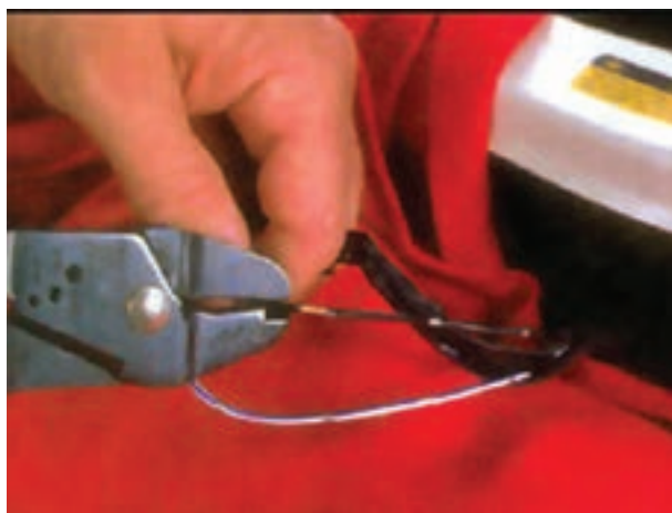
شکل ۱-۱۴۶- استفاده از انبر مخصوص برای قطع سیم
