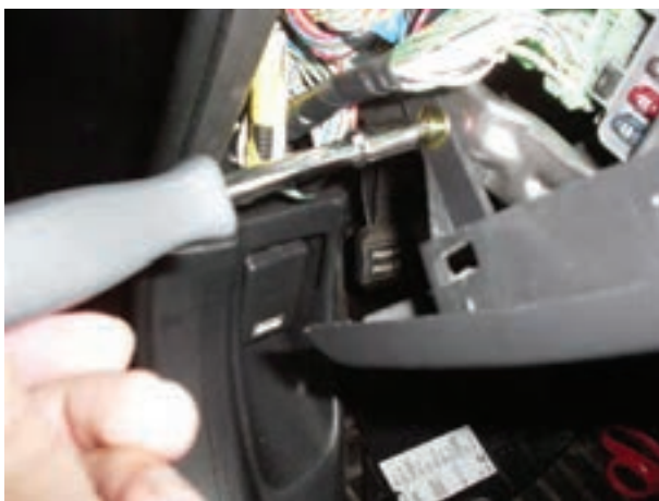
شکل ۱-۸۴- باز کردن پیچ اتصال قاب زیرین به بدنه
