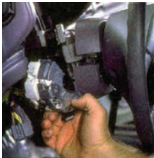
شکل ۱-۹۶- خارج کردن سوئیچ روشنایی از محل خود
