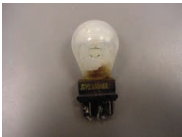
شکل ۱۴۱-۱- اثر عوامل فیزیکی در معیوب شدن لامپ
