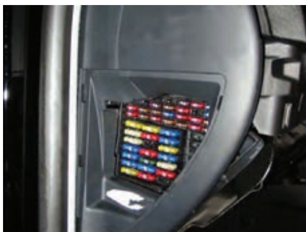
شکل ۱۱۹-۱- جعبه‌ی فیوزی تعبیه شده در روی پانل یک نوع خودرو
