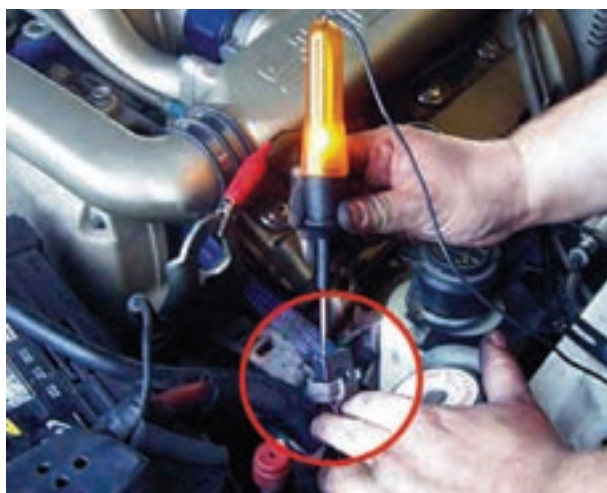
شکل ۱۴۵-۱- آزمایش برقراری جریان مدار چراغ‌های روشنایی
