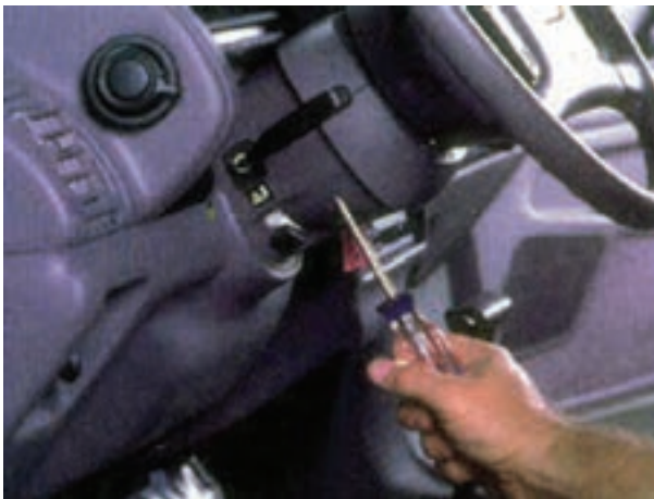
شکل ۱-۹۰- باز کردن پیچ‌های قاب سوئیچ روشنایی
