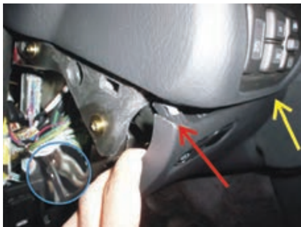
شکل ۱-۸۵- خارج کردن قاب از روی بدنه‌ی پانل
