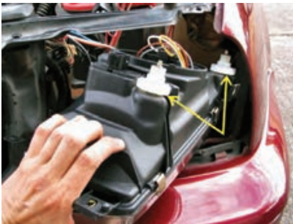
شکل ۱-۱۵۶- اهرم تنظیم کاسه چراغ یک نوع خودرو
