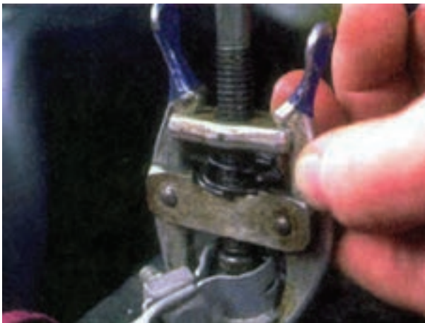
شکل ۱-۸۹- باز کردن بست اتصال بدنه‌ی باتری
