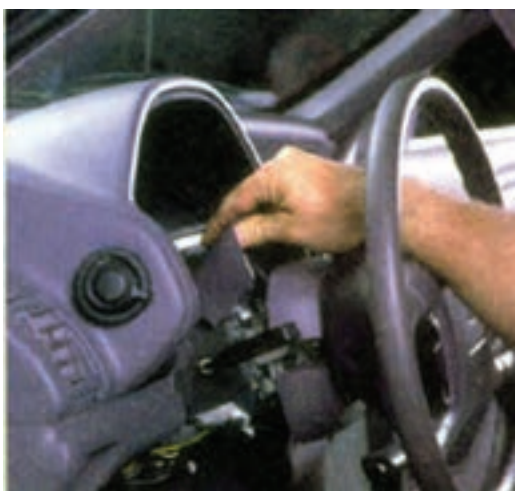
شکل ۹۱-۱- بیرون آوردن قاب سوئیچ روشنایی
