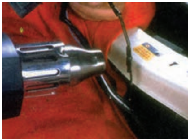
شکل ۱-۱۵۰- عایق کاری محل اتصال سیم ها
