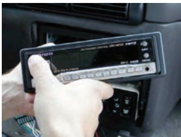
شکل ۲۸-۴- خارج نمودن رادیوپخش از داخل قاب کشویی
