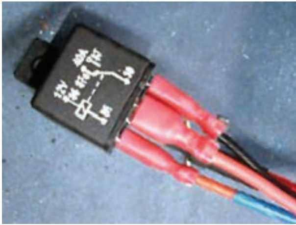
شکل ۸-۴۷- رله‌ی مورد استفاده در مدار الکتریکی پمپ بنزین
