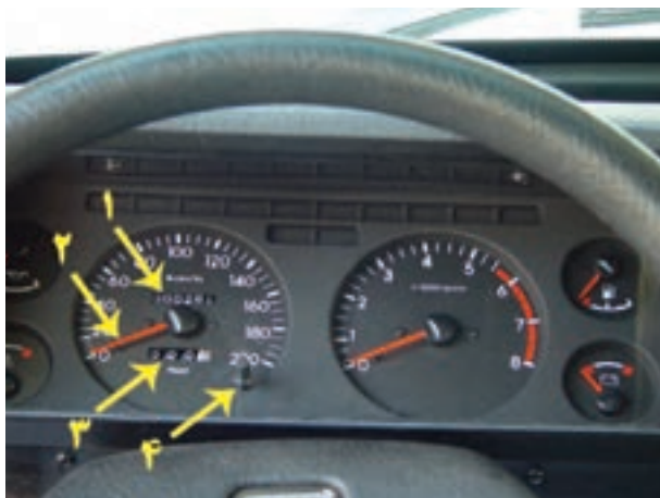
۱- کیلومتر شمار اصلی ۲- سرعت سنج ۳- مسافت سنج ۴- صفر کن مسافت سنج
