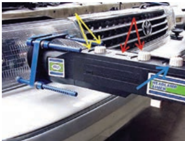
شکل ۱۶۱-۱ پیچ‌های تنظیم دستگاه تنظیم نور چراغ‌ها
