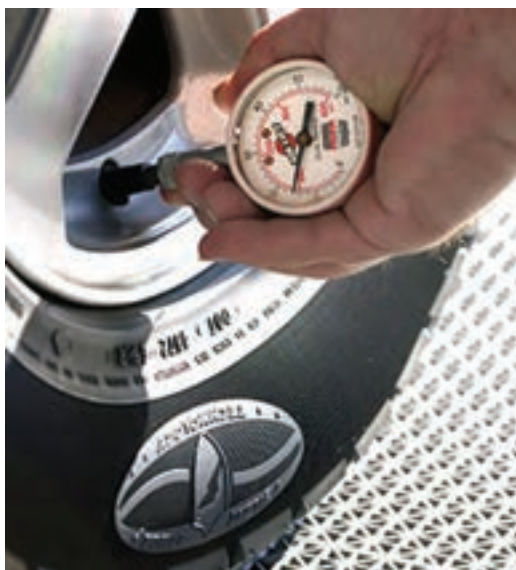
شکل ۱۵۸-۱- کنترل فشار باد تایر
