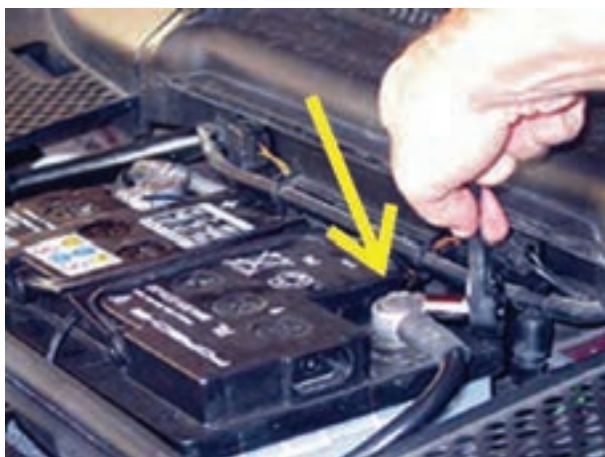
شکل ۱۴۱-۲ باز کردن کابل اتصال بدنه‌ی باتری
