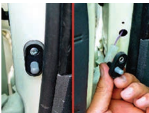
شکل ۱۹۲-۱- باز کردن سوئیچ لای در
