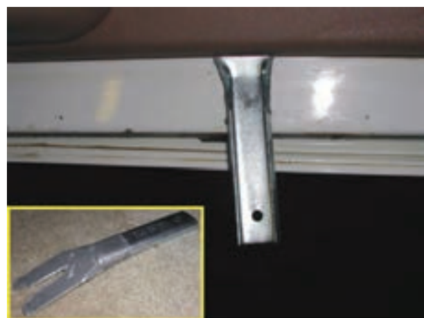
شکل ۲-۳۵- اهرم خاردرآر و نحوه‌ی استفاده از آن
