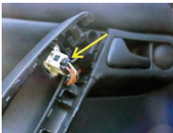
شکل ۲-۱۱۱- سوکت سوئیچ شیشه بالابر
