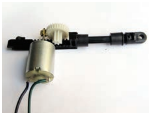
شکل ۲۰-۲ نحوه‌ی ارتباط چرخ‌دنده‌ها هنگام تبدیل دور
