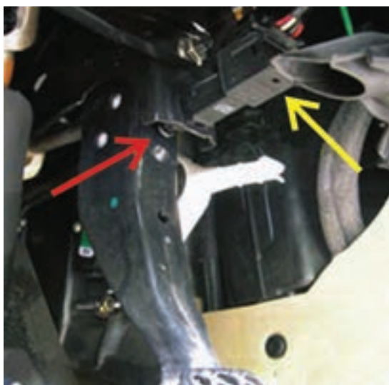
شکل ۱-۷۷- محل نصب سوئیچ مکانیکی ترمز
