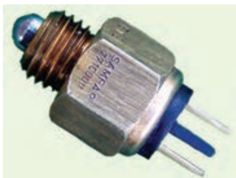
شکل ۱-۷۸- سوئیچ چراغ‌های دنده عقب
