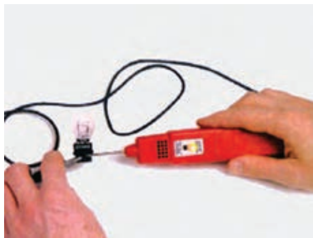
شکل ۱-۲۱۹- آزمایش لامپ چراغ صندوق عقب خودرو
