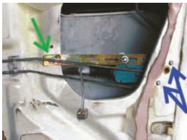
شکل ۳۹-۲ باز کردن پیچ‌های اتصال عملگر الکتریکی
