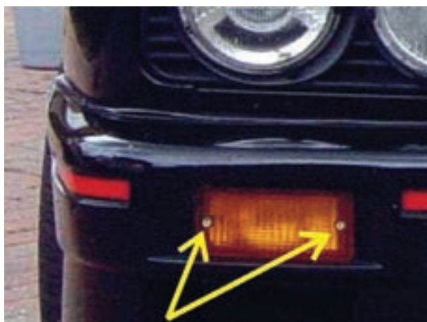
شکل ۱-۵۰ پیچ‌های اتصال تلق چراغ راهنما
