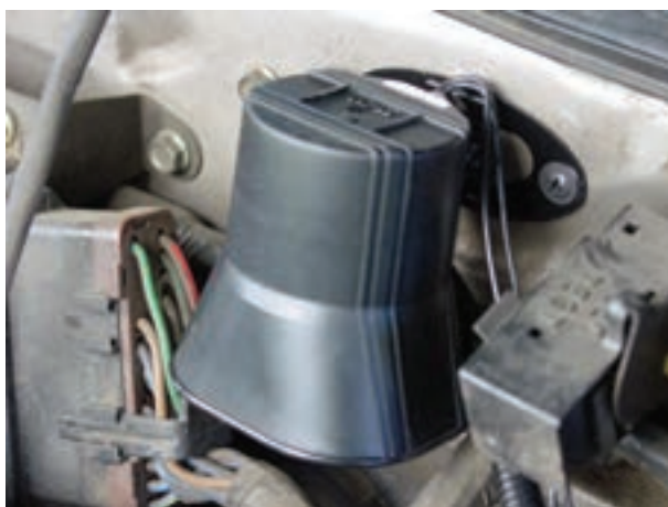
شکل ۵۸-۲ یک نوع آژیر سیستم دزدگیر خودرو
