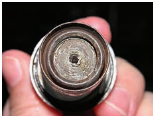
شکل ۱-۲۲۵- المنت حرارتی داخل سوئیچ فشاری
