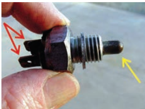
شکل ۱۰۴- پلانجر و ترمینال‌های سوئیچ دنده عقب
