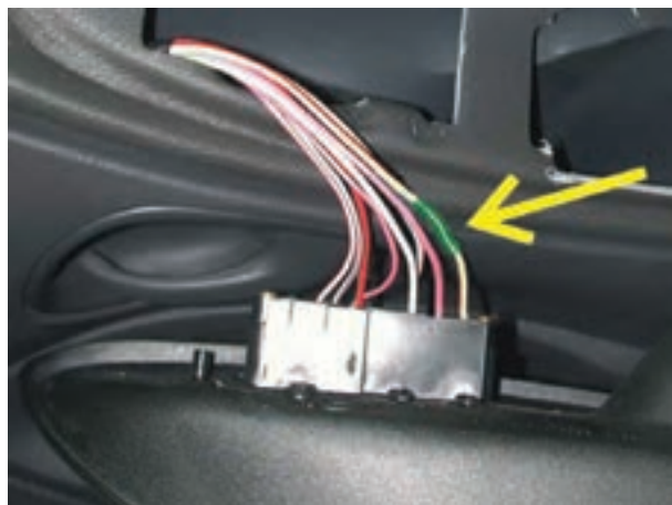
شکل ۱۵۳-۲- عایق‌کاری محل اتصال سیم قطع شده
