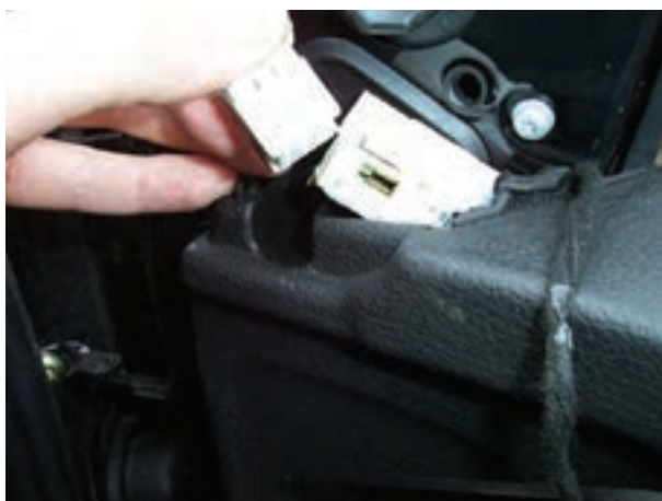
شکل ۱۶۶-۲- جدا کردن سوکت سیم کشی آینه
