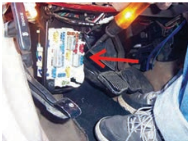
شکل ۱۲۰-۱ آزمایش جعبه‌ی فیوز با چراغ آزمایش
