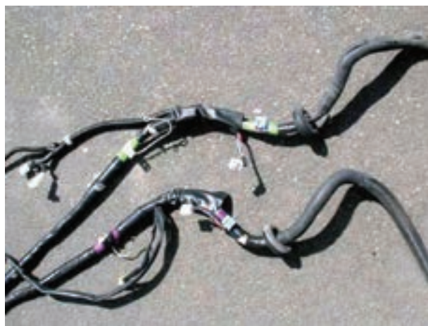
شکل ۱۳۷-۱- کلاف سیم کشی یک نوع خودرو
