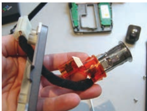
شکل ۱-۲۳۴- خارج کردن سیم و سوکت اتصال الکتریکی فندک از داخل قاب روی پانل
