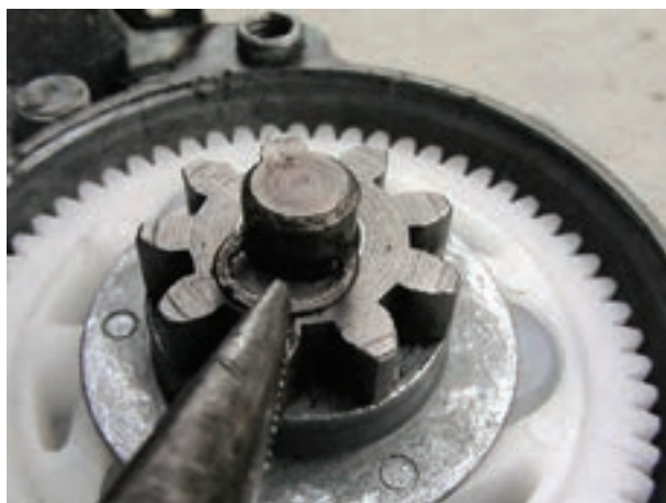
شکل ۱۲۹-۲ جانداختن خار فنری
