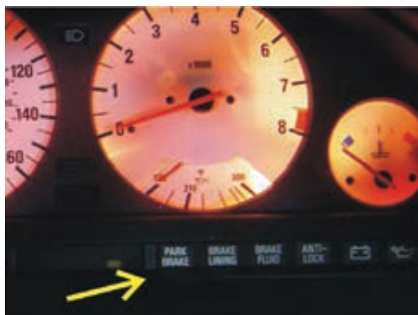
شکل ۱-۲۰۵ - چراغ‌های اخطار سیستم ترمز
