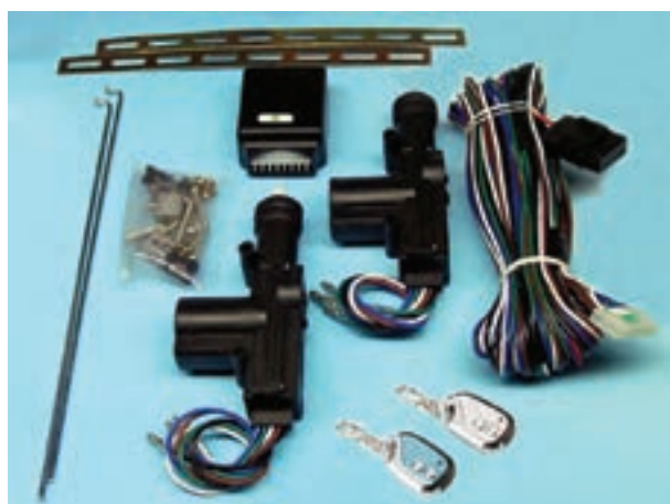
شکل ۲-۱- اجزای مدار قفل مرکزی
