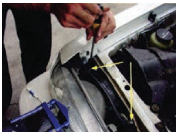
شکل ۱۶۷-۱- پیچ‌های تنظیم چراغ بزرگ جلو
