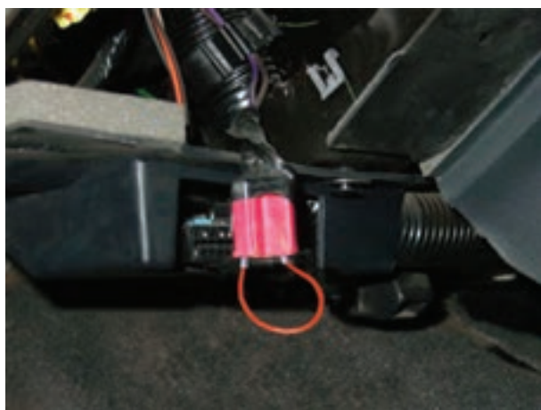
شکل ۱۲۹-۱ یک سره کردن مدار راهنما
