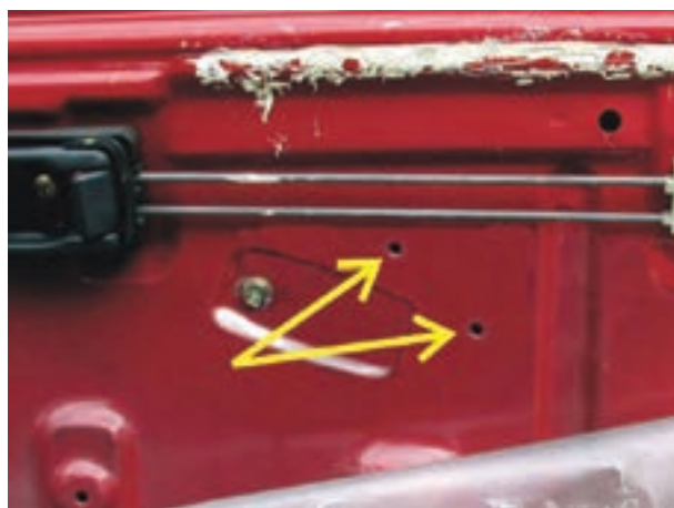
شکل ۲-۲۷ سوراخ کاری بدنه‌ی داخلی در خودرو
