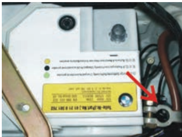
شکل ۲-۱۰۹- باز کردن اتصال منفی باتری
