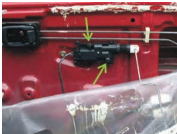
شکل ۲-۲۹ اتصال عملگر الکتریکی در روی در خودرو
