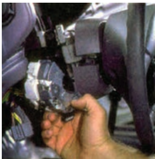
شکل ۱-۹۶- خارج کردن سوئیچ روشنایی از محل خود
