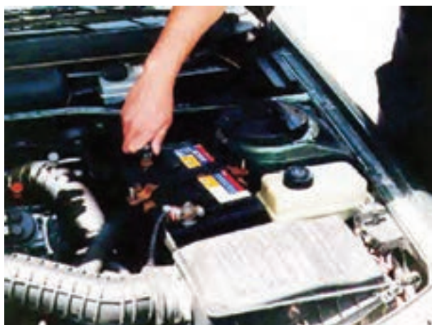
شکل ۱۶۴-۲ بازکردن کابل اتصال بدنه‌ی باتری
