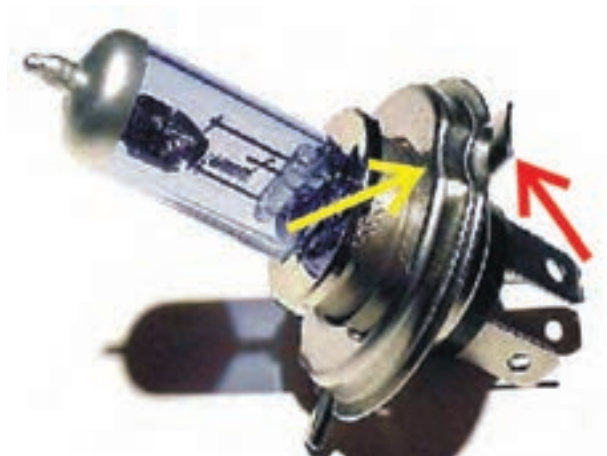
شکل ۱-۲۸ زائده و تورفتگی در ساختمان بدنه‌ی لامپ چراغ بزرگ
