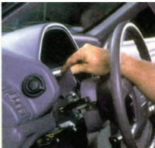
شکل ۹۱-۱- بیرون آوردن قاب سوئیچ روشنایی
