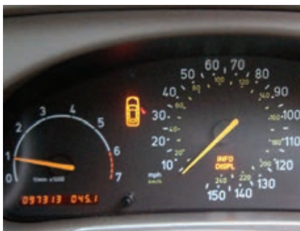
شکل ۲۱۳-۱- چراغ خطر بازبودن درهای خودرو
