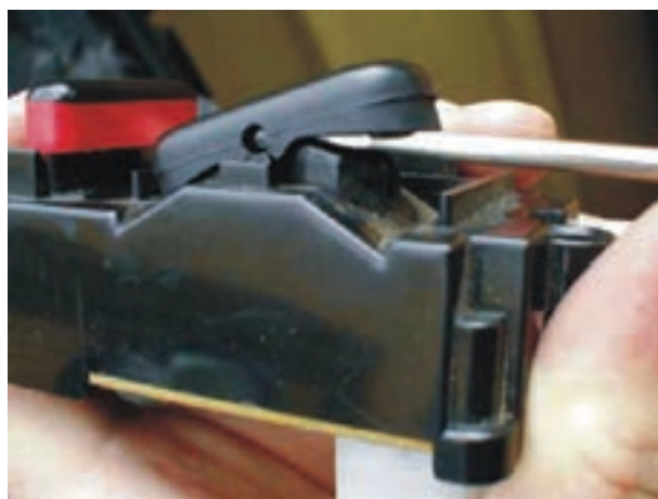
شکل ۲-۱۴۵ - تعویض شستی معیوب
