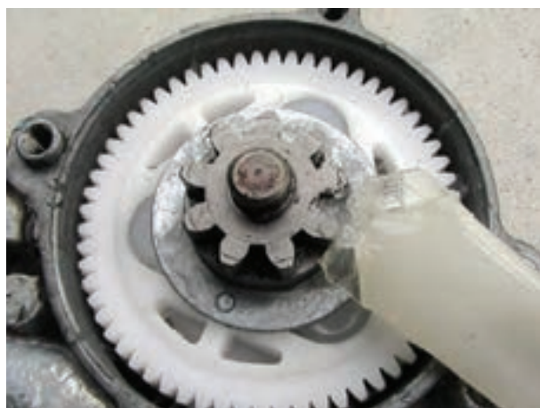
شکل ۱۳۰-۲- روغن کاری چرخ دنده ها
