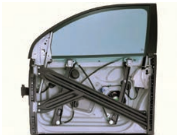
شکل ۹۶-۲- شیشه بالابر الکتریکی
