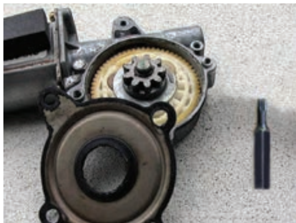
شکل ۱۲۴-۲- اجزای داخل جعبه دنده‌ی تعدیل دور
