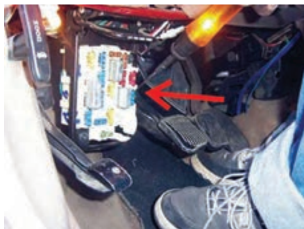
شکل ۱۸۹-۲- آزمایش پایه‌های فیوز
