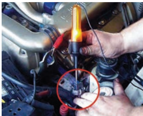
شکل ۱-۱۴۵- آزمایش برقراری جریان مدار چراغ‌های روشنایی
