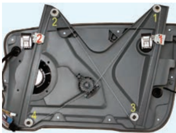
شکل ۱۰۶-۲- نحوه‌ی ارتباط رگلاتورهای مکانیزم شیشه بالابر
