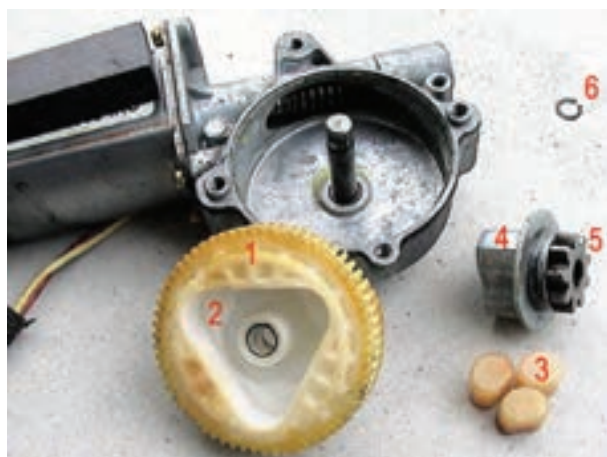
شکل ۱۲۵-۲- اجزای داخل پوسته‌ی گیربکس تعدیل دور
