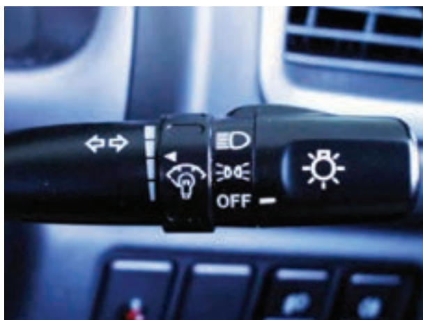
شکل ۱-۷۲- سوئیچ چراغ‌های روشنایی (طرح دسته‌ی راهنما)
