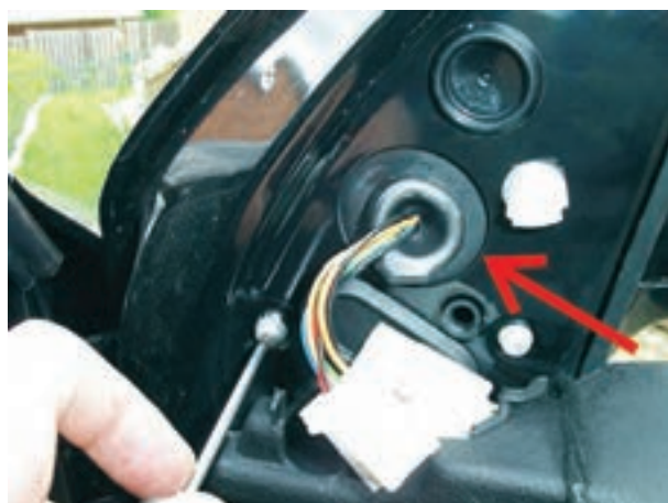
شکل ۱۷۸-۲ بازکردن پیچ نگه دارنده‌ی پایه‌ی اصلی آینه
