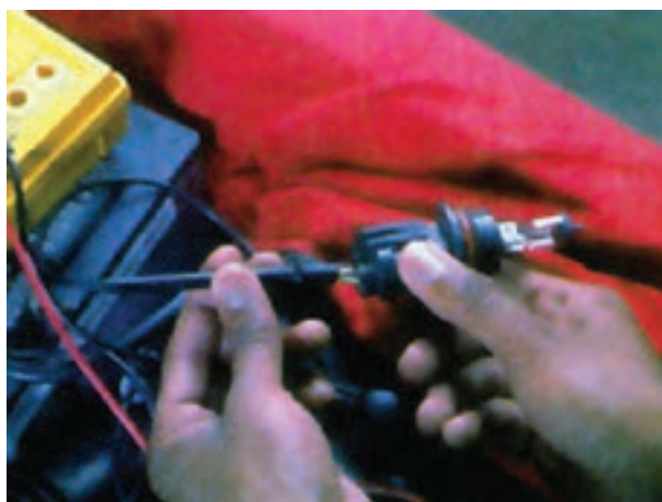
شکل ۱۴۲- آزمایش لامپ چراغ‌های بزرگ جلو
