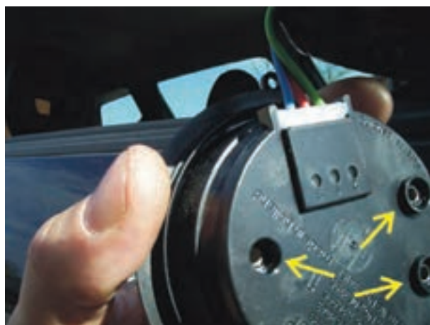
شکل ۱۷۲-۲ جدا کردن محفظه‌ی موتورهای الکتریکی
