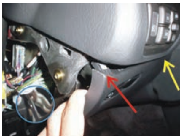
شکل ۱-۸۵- خارج کردن قاب از روی بدنه‌ی پانل
