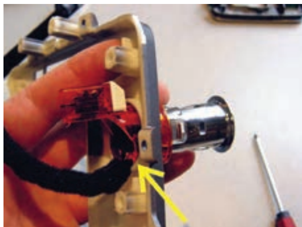
شکل ۱-۲۳۲- خارج کردن فندک
