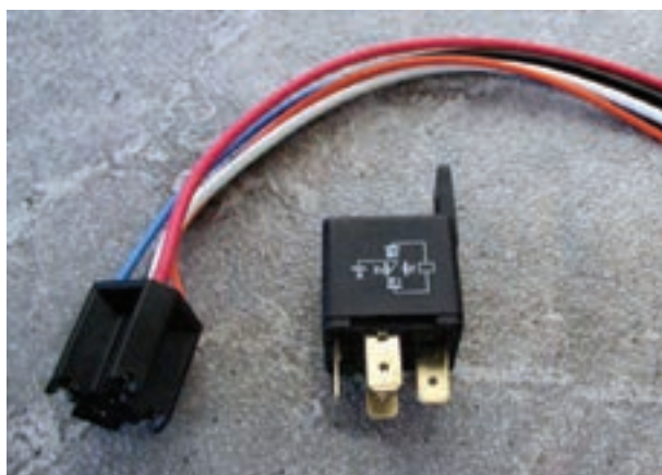
شکل ۱-۱۲۲- یک نوع آفتامات مدار الکتریکی خودرو
