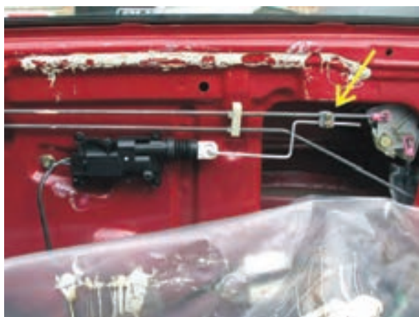
شکل ۲-۳۱- اتصال میله‌ی رابط عملگر الکتریکی به اهرم‌بندی قفل در خودرو
