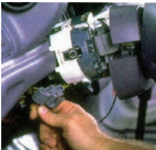
شکل ۱-۹۴- جدا کردن سوکت اتصال الکتریکی
