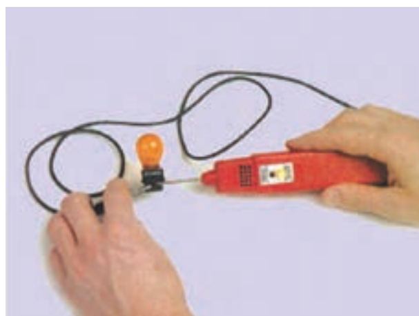
شکل ۱۸۲-۱- آزمایش لامپ چراغ راهنما
