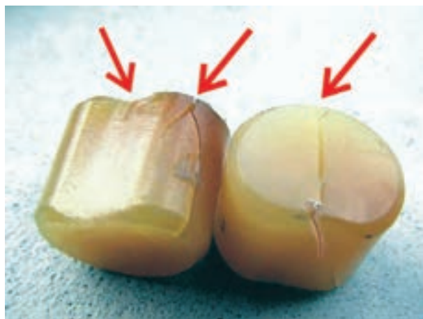
شکل ۱۲۶-۲- معیوب بودن بادامک‌ها
