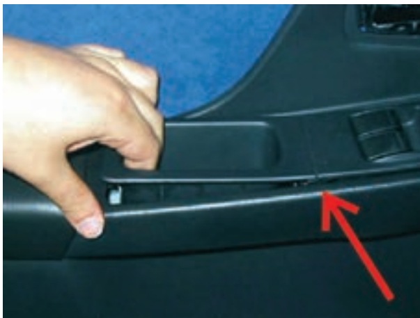
شکل ۲-۱۸۳ خارج نمودن قاب سوئیچ‌ها
