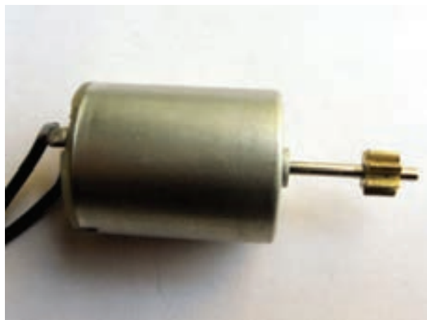
شکل ۲-۱۷- موتور الکتریکی عملگر
