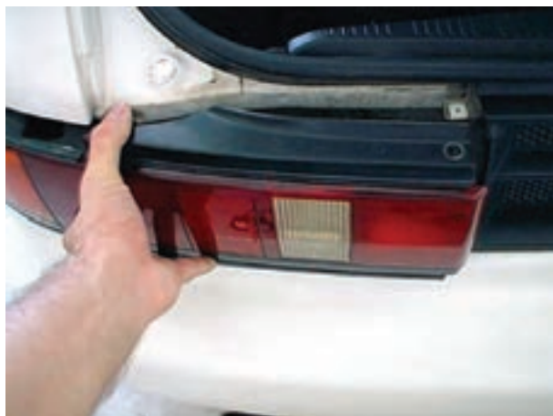
شکل ۱-۵۸- جدا کردن چراغ عقب از بدنه‌ی خودرو
