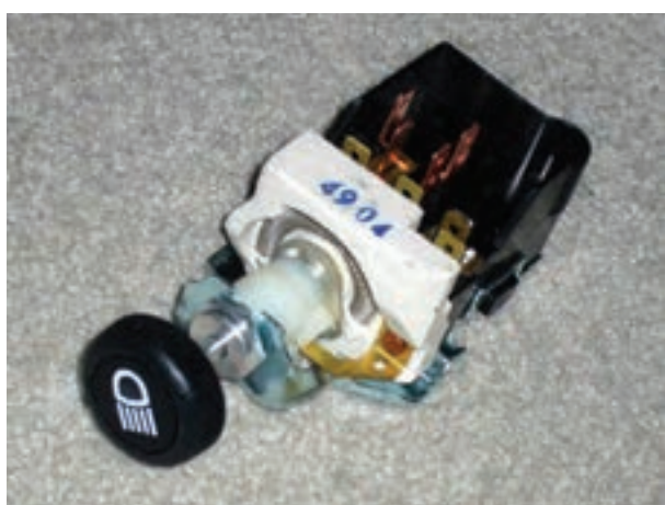
شکل ۱-۷۱- سوئیچ چراغ‌های روشنایی نوع چرخشی
