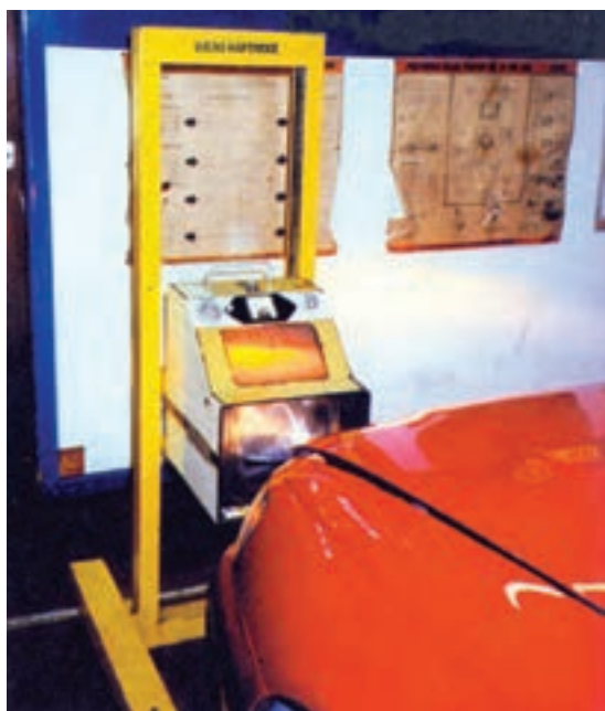
شکل ۱-۱۵۳- یک نوع دستگاه تنظیم نور چراغ‌های بزرگ
