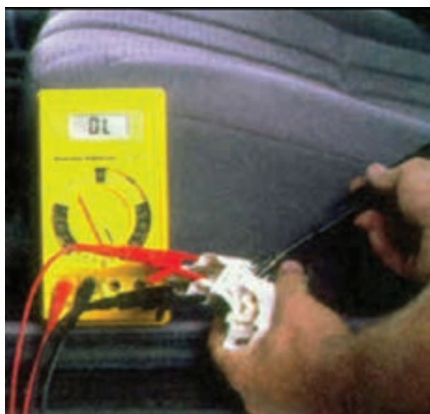
شکل ۹۸-۱ آزمایش حالت استپ موقت دسته ی راهنما
