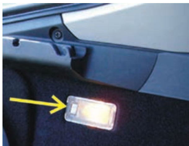
شکل ۱-۲۱۸- چراغ صندوق عقب و سوئیچ روی آن
