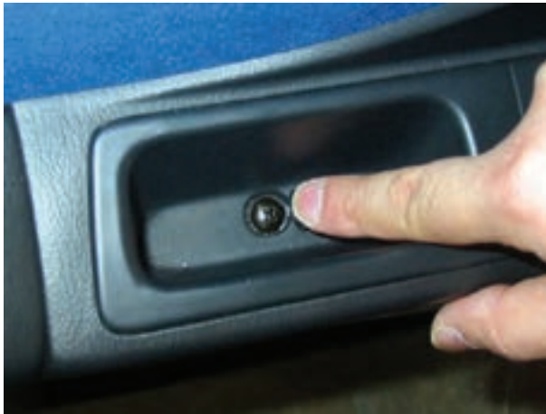
شکل ۲-۱۸۲ پیچ اتصال قاب سوئیچ به بدنه
