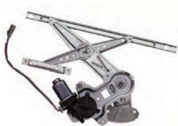
شکل ۲-۹۹- مکانیزم شیشه بالابر یک نوع خودرو
