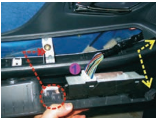
شکل ۲-۱۸۴ خارهای فلزی روی قاب سوئیچ‌ها و محل قرار گرفتن آن‌ها
