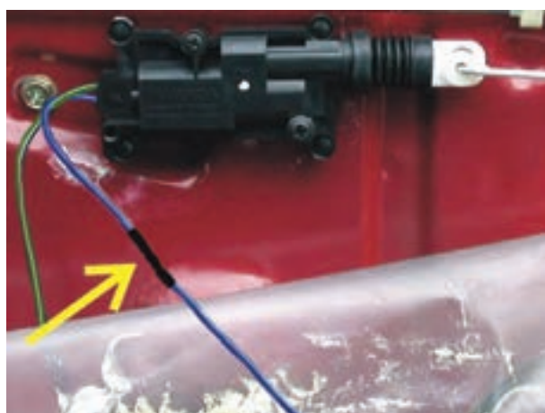
شکل ۴۹-۲ عایق کاری محل اتصال سیم ها به یکدیگر
