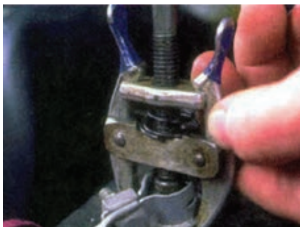
شکل ۱-۸۹- باز کردن بست اتصال بدنه‌ی باتری
