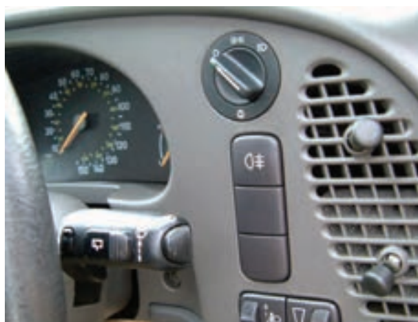
شکل ۱-۶۹- یک نوع سوئیچ روشنایی
