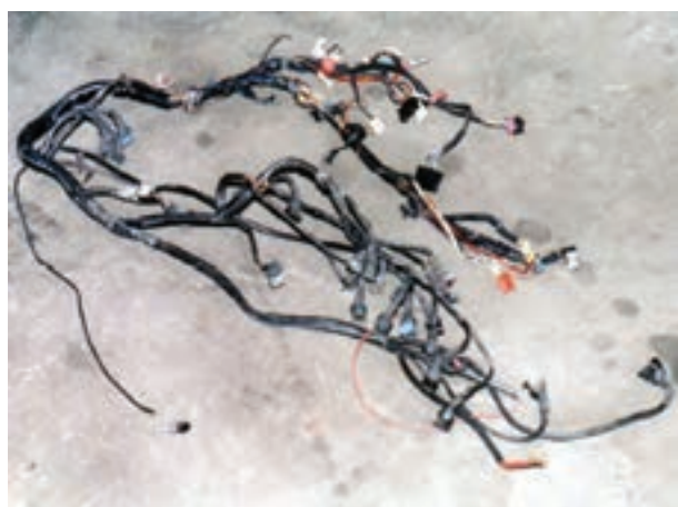
شکل ۱۳۳-۱- دسته‌ی سیم‌های یک نوع خودرو
