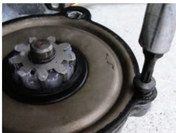
شکل ۱۳۱-۲- بستن پیچ های درپوش به بدنه
