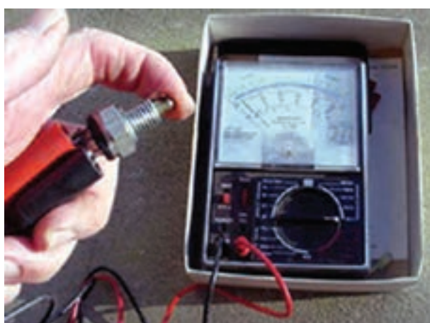
شکل ۱۰۵-۱- آزمایش سوئیچ چراغ‌های دنده عقب
