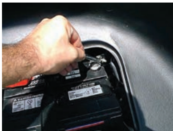
شکل ۱-۵۲ باز کردن بست ترمینال منفی باتری
