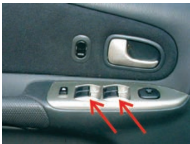
شکل ۱۳۵-۲ سوئیچ های شیشه بالابر در سمت راننده
