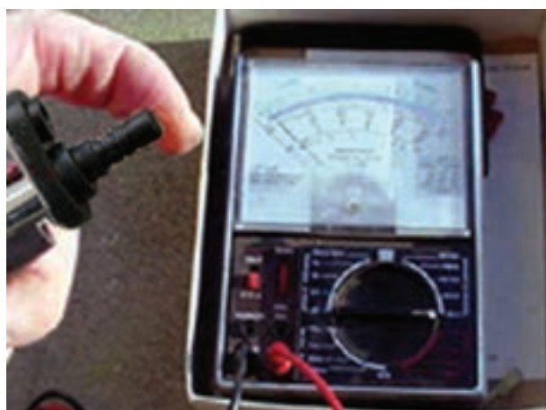
شکل ۱۹۶-۱- آزمایش سوئیچ لای در
