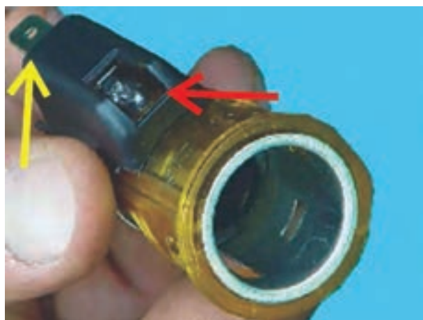
شکل ۱-۲۲۴- لامپ فندک و ترمینال الکتریکی آن
