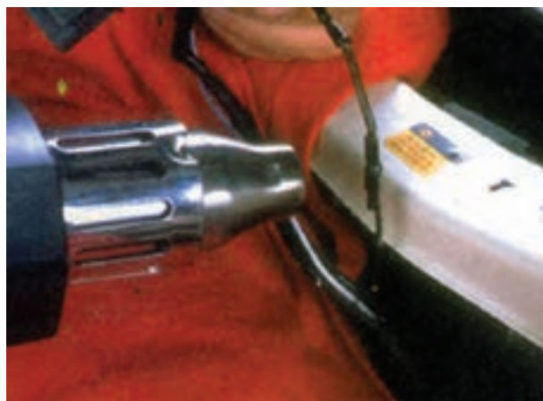
شکل ۱۵۰-۱- عایق کاری محل اتصال سیم ها
