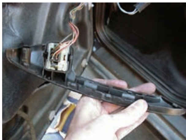
شکل ۱۱۸-۲ اتصال سوکت سوئیچ شیشه بالابر
