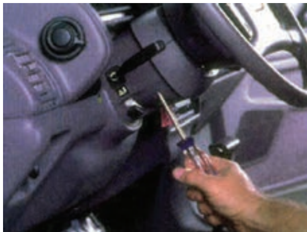
شکل ۱-۹۰- باز کردن پیچ‌های قاب سوئیچ روشنایی
