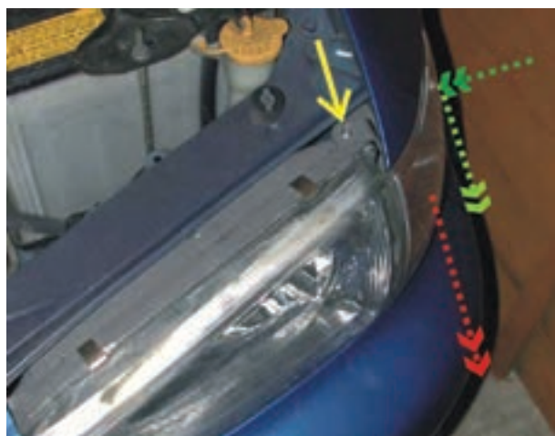
شکل ۱-۳۸- نحوه‌ی جداکردن چراغ جانبی روشنایی
