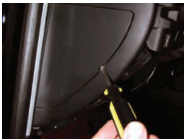
شکل ۱۱۸-۱ آزاد کردن خار پوشش محفظه‌ی جعبه‌ی فیوز
