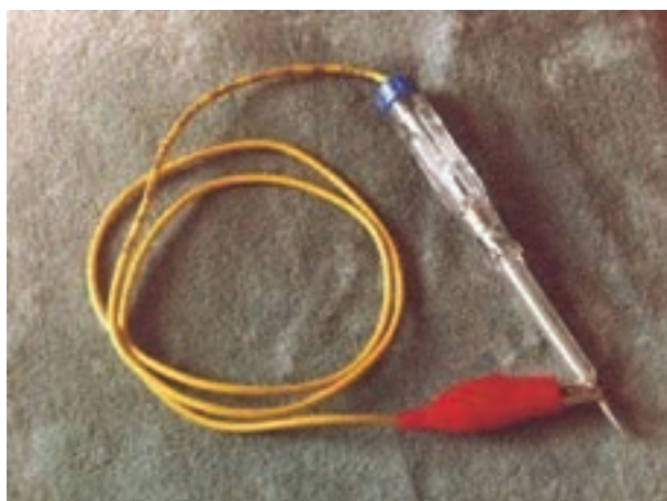
شکل ۱-۱۲۱- چراغ آزمایش بدون باتری
