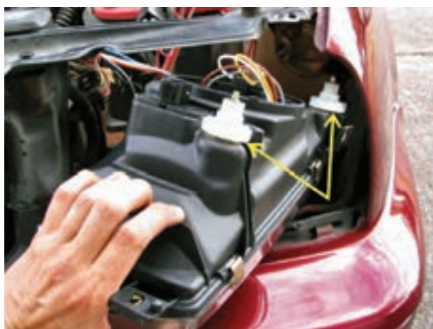
شکل ۱۵۶-۱- اهرم تنظیم کاسه چراغ یک نوع خودرو
