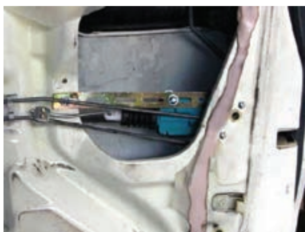
شکل ۲-۳۷- نحوه‌ی اتصال عملگر الکتریکی
