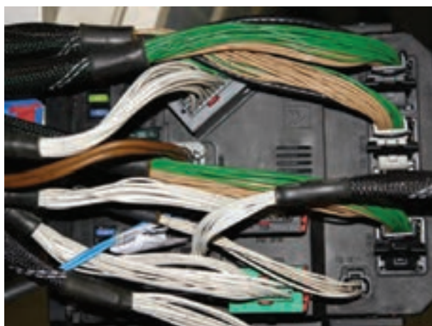
شکل ۱۳۶-۱- اتصال سیم کشی به جعبه ی فیوز در یک نوع خودرو
