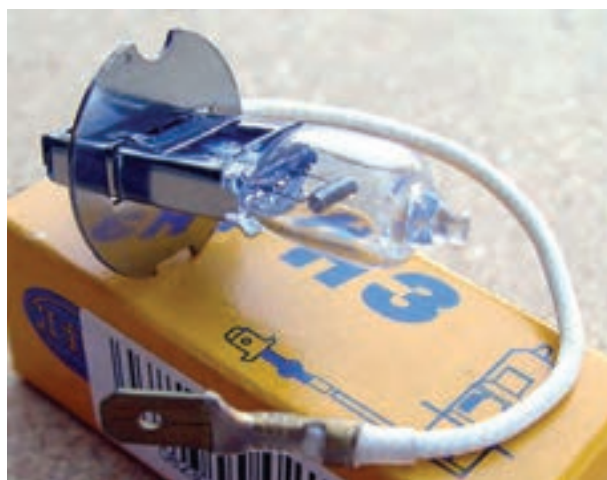
شکل ۱-۳۱- لامپ مورد استفاده در چراغ‌های مه‌شکن، نورافکن‌ها
