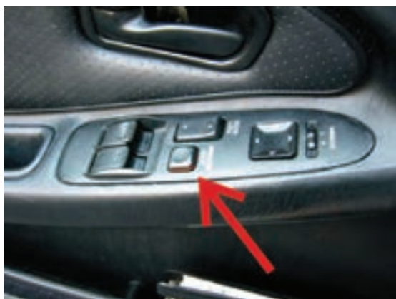
شکل ۱۳۷-۲- سوئیچ قفل کن سیستم شیشه بالابر
