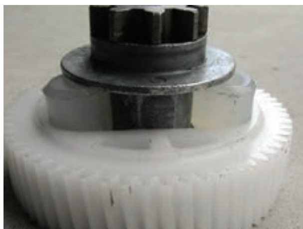
شکل ۱۲۸-۲ سوار کردن چرخ دنده‌ی فلزی
