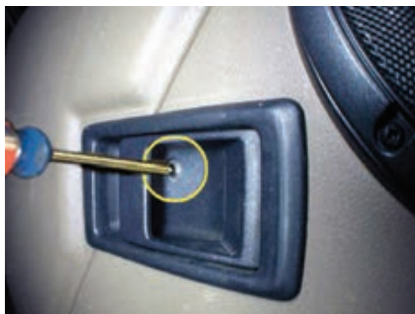
شکل ۲-۳۶- باز کردن قاب دستگیره‌ی قفل در
