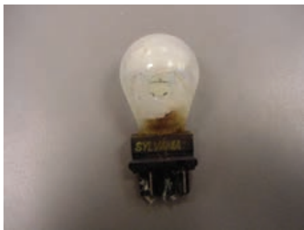
شکل ۱۴۱- اثر عوامل فیزیکی در معیوب شدن لامپ
