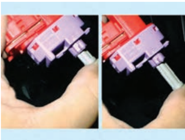
شکل ۱۹۹-۱- عملکرد پلانجر سوئیچ جعبه‌ی داشبورد
