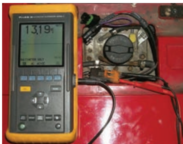
شکل ۸-۴۶ - اندازه گیری ولتاژ مدار
