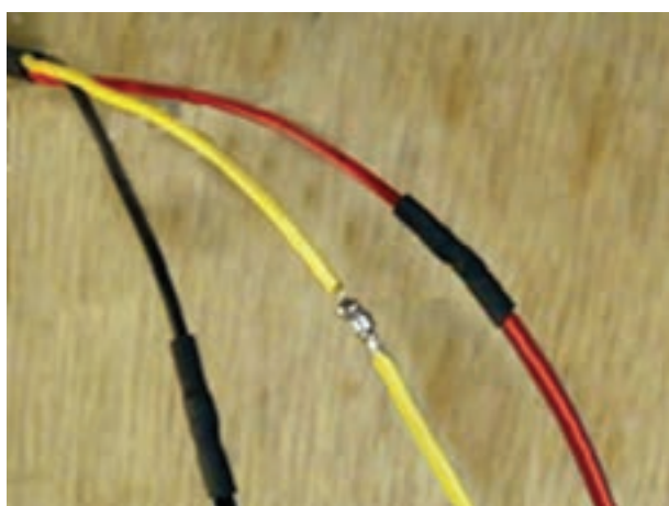
شکل ۱-۷۴- رفع عیب سیم‌کشی مدار الکتریکی
