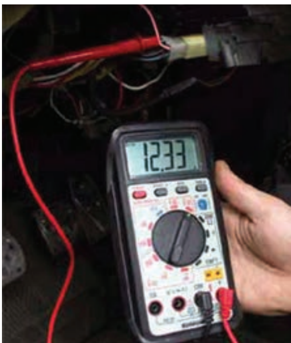
شکل ۲۸-۱۱ اندازه‌گیری ولتاژ در ترمینال ورودی سوئیچ
