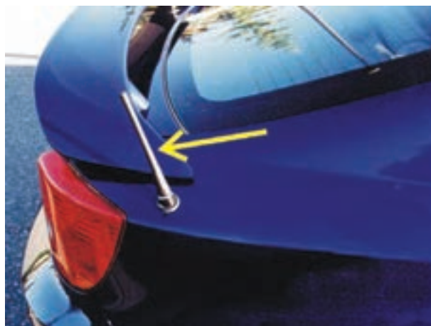
شکل ۵-۱۶- باز شدن میله‌ی آنتن
