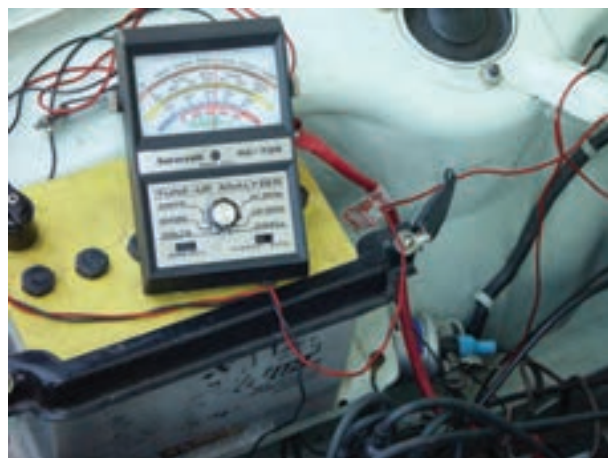
شکل ۱۰-۱۳- مقادیر زاویه‌ی نشست پلاتین (دول)
