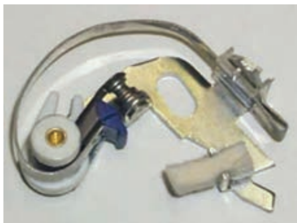
شکل ۲۲-۱۰ نمد روغن کاری بادامک
