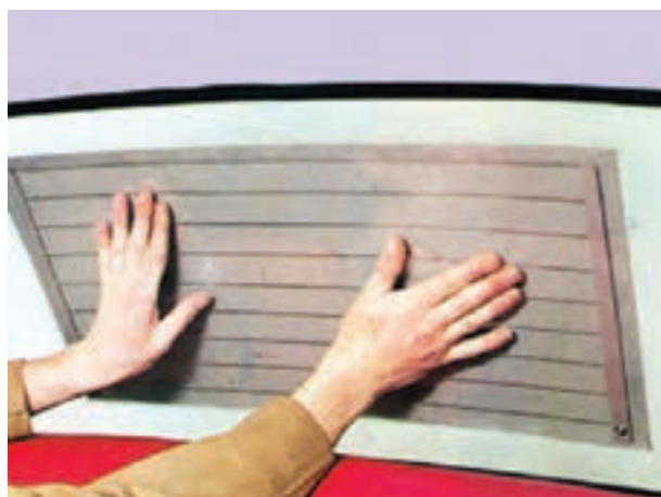
شکل ۳-۹- نحوه چسباندن المنت حرارتی
