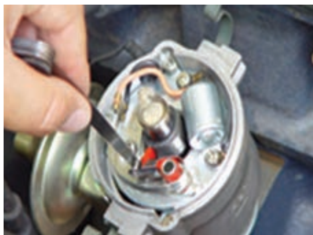
شکل ۴۸-۱۰ قرار دادن فیلر در دهانه‌ی پلاتین
