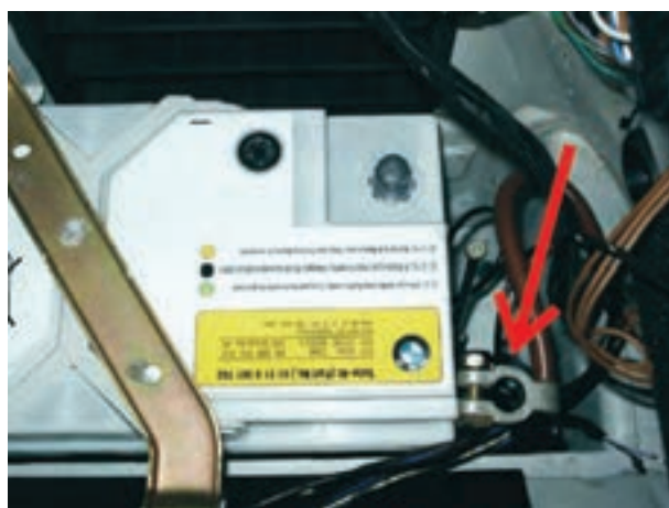
شکل ۹-۱۱- باز کردن کابل اتصال بدنه‌ی باتری
