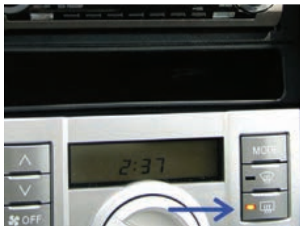
شکل ۳-۱۷- سوئیچ شیشه گرم‌کن در حالت (on)
