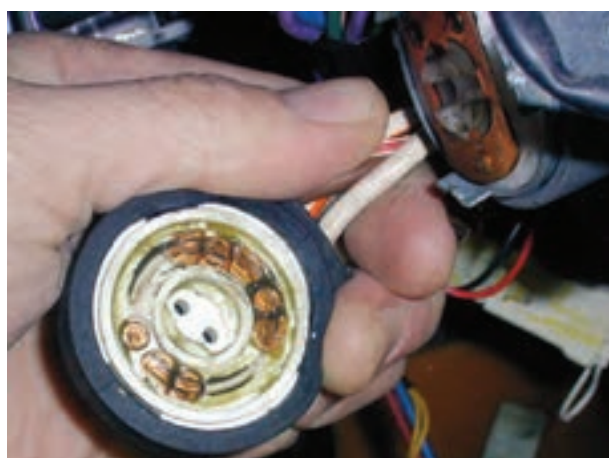
شکل ۱۱-۱۴- ترمینال داخل فیبری سوئیچ
