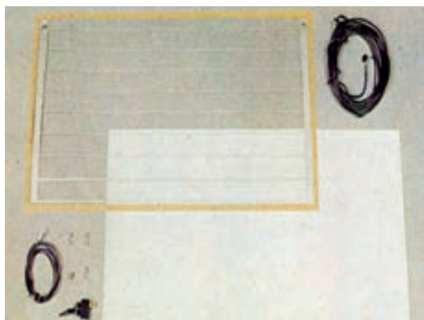
شکل ۳-۶- مجموعه قطعات گرم‌کن شیشه
