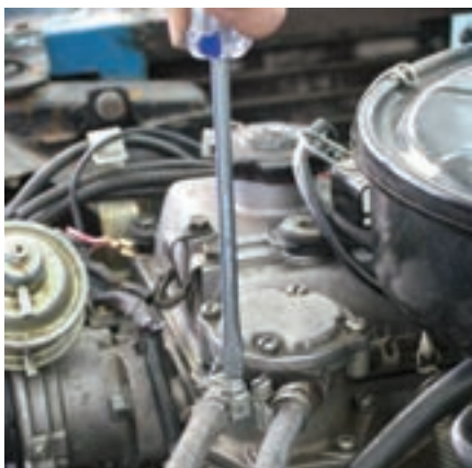
شکل ۱-۴۴-ب: نصب لوله‌ها
