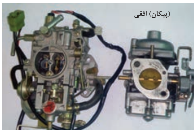
شکل ۱-۶۴ کاربراتورها از نظر حرکت سوخت (نزولی - افقی)
