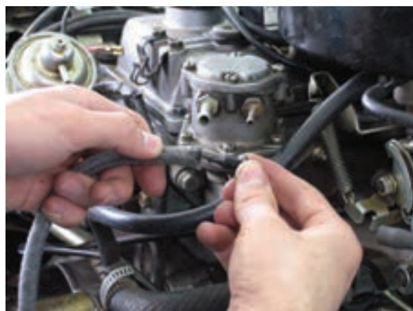
شکل ۱-۴۱ جدا کردن لوله‌ها
