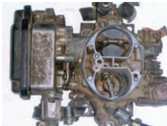
شکل ۱-۸۰ دریچه ساسات در کاربراتور دودخانه با راه‌اندازی بی‌متال
