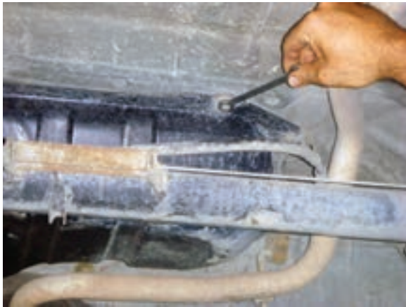
شکل ۱-۲۵ باز کردن پیچهای دور باک
