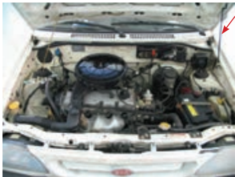
شکل ۱۱۹- ۱ نصب صحیح اهرم نگه‌دارنده درپوش موتور خودرو
