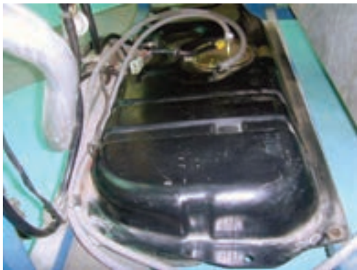
شکل ۱-۲۷ مخزن نصب شده و آماده سوخت گیری
