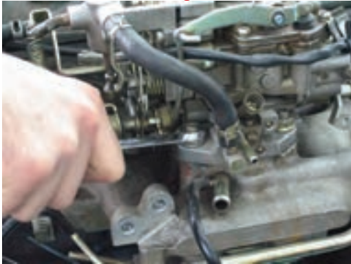
شکل ۱-۱۱۰ باز کردن پیچ‌های اتصال کاربراتور به موتور
