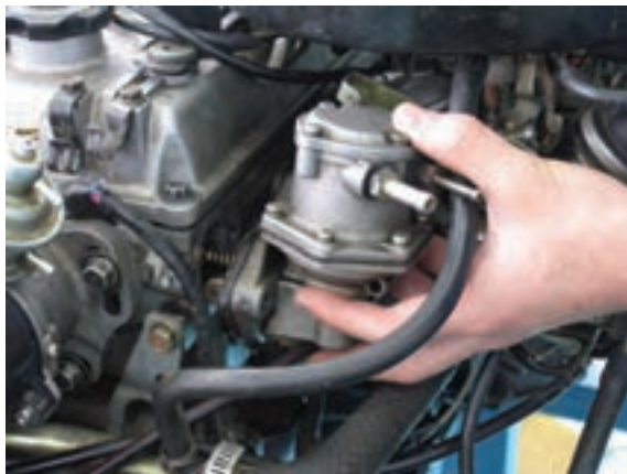
شکل ۱-۴۴ الف: نصب پمپ
