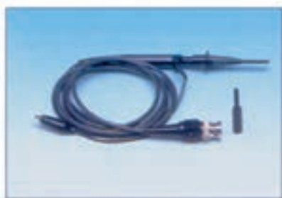
شکل ۸۵-۱ کاربرد کابل کواکسیال در پراب اسپلوسکوپ
