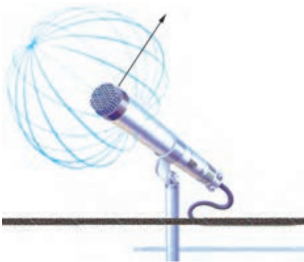
شکل ۱-۱۲۵-۱ منحنی مشخصه میکروفون
