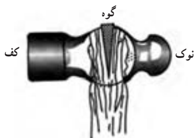
شکل ۳-۷۵- اتصال چکش به دسته
