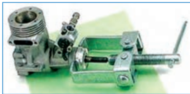
شکل ۷۷-۳- خارج کردن بلبرینگ با بلبرینگ کش
