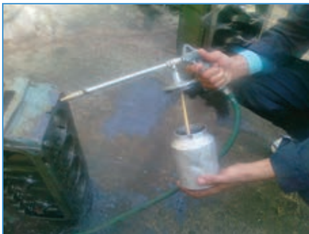
شکل ۱-۳- باز کردن مخزن پیستوله شستشو
