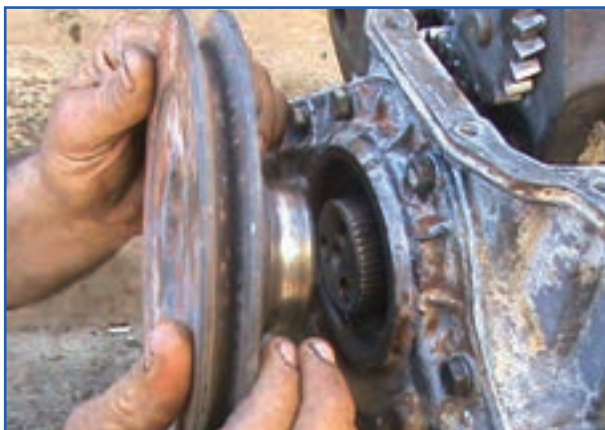
شکل ۴۶-۷- جازدن چرخ تسمه سر میل لنگ
