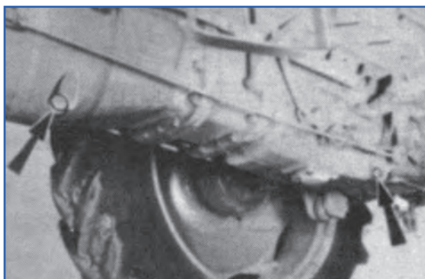
شکل ۶۱-۷- محل قرار گرفتن پیچ تخلیه روغن هیدرولیک MF285
