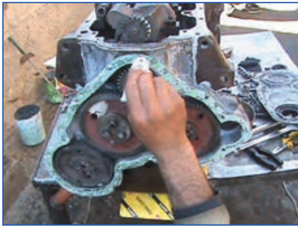
شکل ۴۴-۷- چسب زدن به محل نصب سینی جلو
