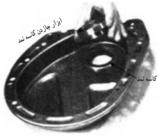
شکل ۴۳-۷- نحوه جازدن کاسه نمد روی سینی جلو
