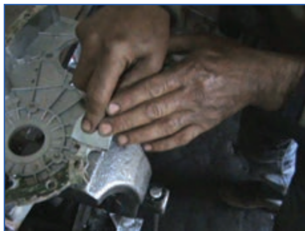
شکل ۴۱-۷- تمیز کردن واشر سینی جلو با کاردک
