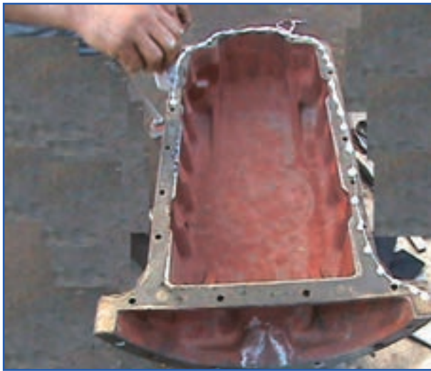
شکل ۳۲-۷- چسب زدن به محل قرارگیری واشر کارتر
