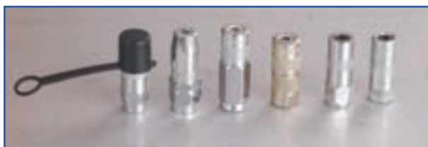
شکل ۵۱-۷- انواع سر گریس پمپ
