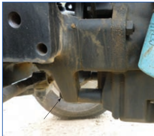
شکل ۱۷-۳- محل پیچ‌های اتصال موتور به جلوی تراکتور
