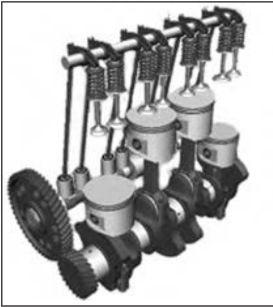
شکل ۸-۲ - قطعات مکانیزم باز و بسته شدن سوپاپها
