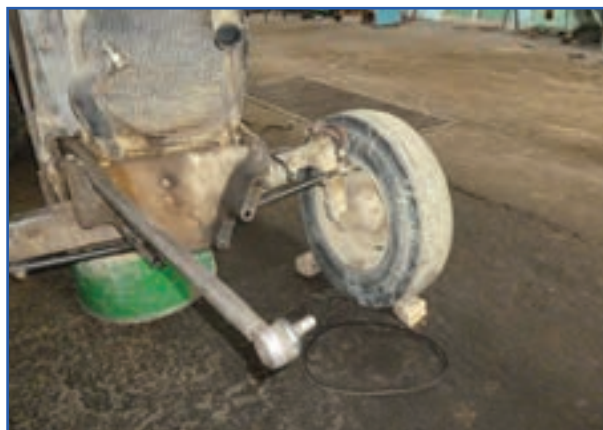
شکل ۱۹-۳- قسمت جلوی تراکتور جدا شده از موتور
