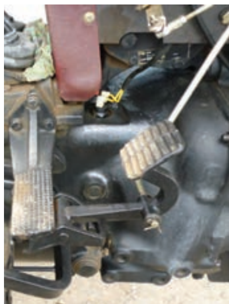
شکل ۱۱-۳- پیچ‌های اتصال موتور به جعبه‌دنده قسمت پایین
