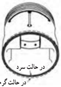
شکل ۱۹-۲- وضعیت پیستون در حالت گرم و سرد
