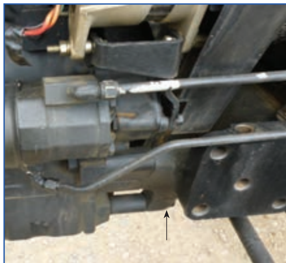
شکل ۱۷-۳- محل پیچ‌های اتصال موتور به جلوی تراکتور
