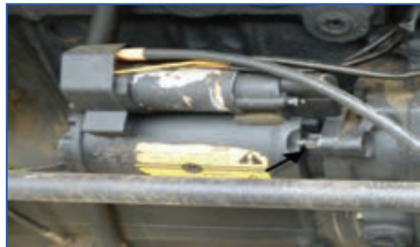
شکل ۳-۸- پیچ های نگهدارنده استارت تر تراکتور MF285
