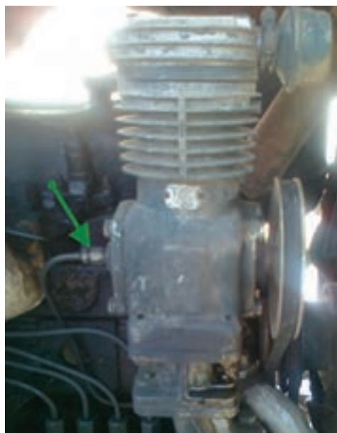
شکل ۵-۸- لوله روغن کاری کمپرسور در تراکتور U650
