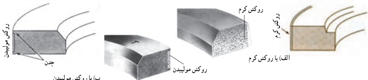
شکل ۲۴-۲- مقطع رینگ‌های تراکم روکش‌دار
