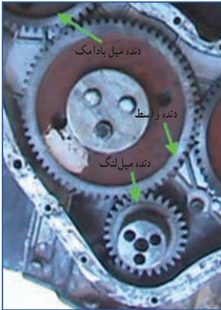
شکل ۱۲-۲- نسبت دنده میل بادامک به میل لنگ
