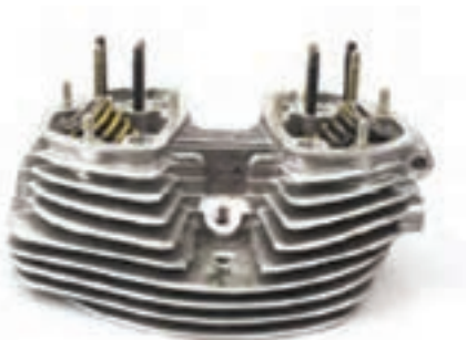
شکل ۳-۲ - سرسیلندر موتور هوا خنک
