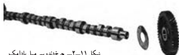
شکل ۱۱-۲ - چرخ‌دنده سر میل بادامک
