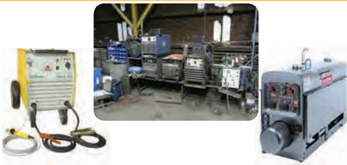
ج) دستگاه‌های جوشکاری نظیر: رکتیفایر، ترانس، دینام و موتور جوش ادامه- برخی از دستگاه‌های موجود در کارگاه‌های جوشکاری
