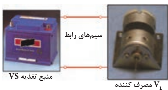
شکل ۵-۹۶ افت ولتاژ بین مولد و مصرف کننده
