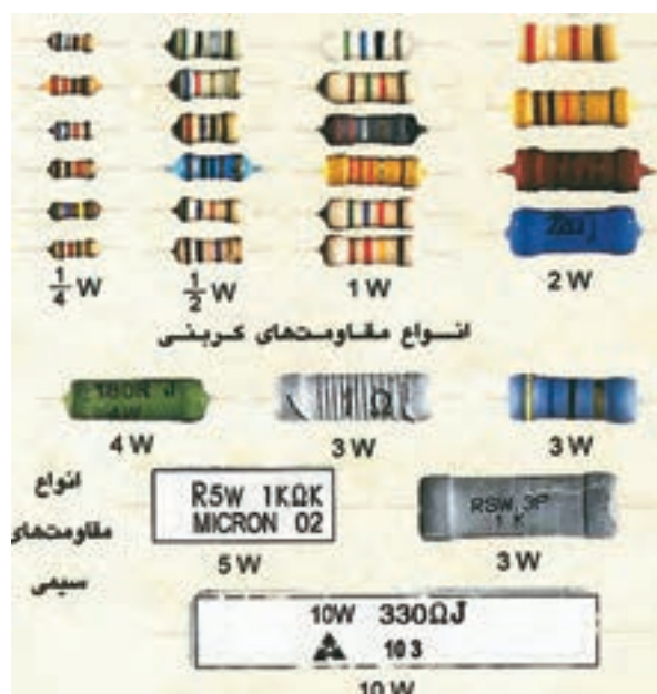
شکل ۱۷-۶- استانداردهای توان در مقاومت ها
