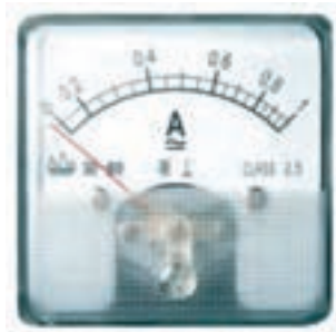
شکل ۹-۳- شکل ظاهری یک نمونه آمپر متر
