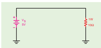
شکل ۶-۱۶- بررسی جریان مصرف کننده براساس توان مجاز
