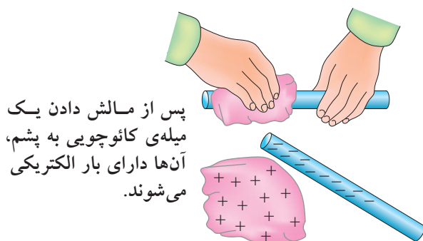
شکل ۱۸-۳- الکتریسیته مالشی (اثر تریبو الکتریک)
