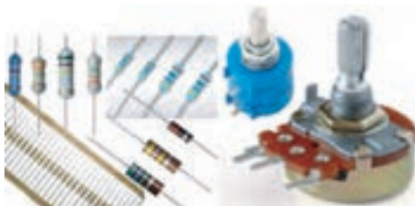
شکل ۳۰-۳- مقاومت های ثابت و متغیر
