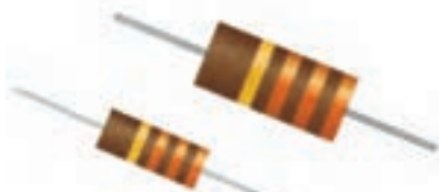
شکل ۳-۶۱ مقاومت توده کربنی
