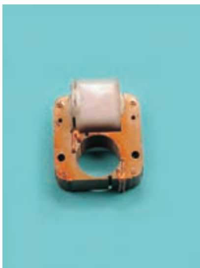
شکل ۲-۲- استاتور موتور قطب چاکدار
