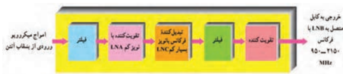
شکل ۴-۲۶ بلوک دیاگرام ساده LNB
