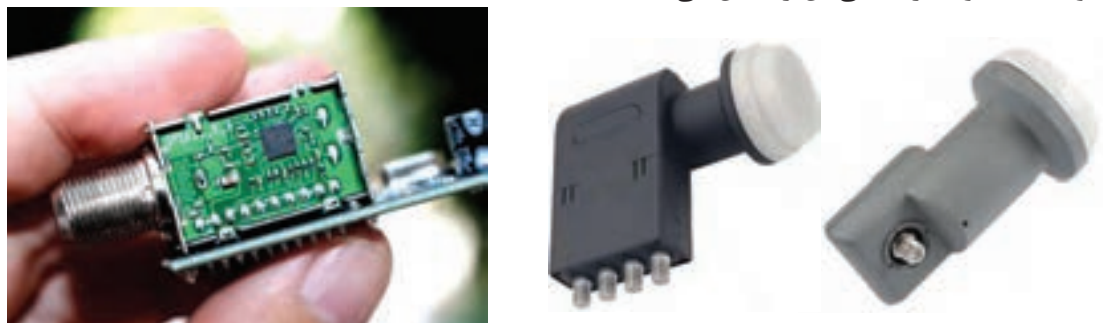
شکل ۴-۲۵ دو نوع LNB و مدار داخلی آن
