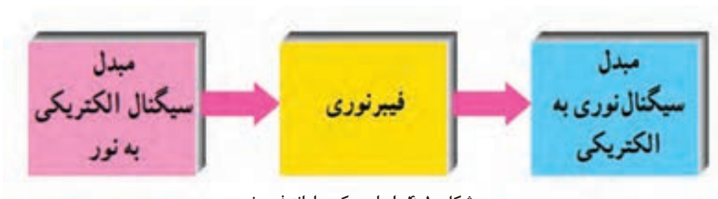
شکل ۴-۱۰- اساس یک سامانه فیبر نوری
