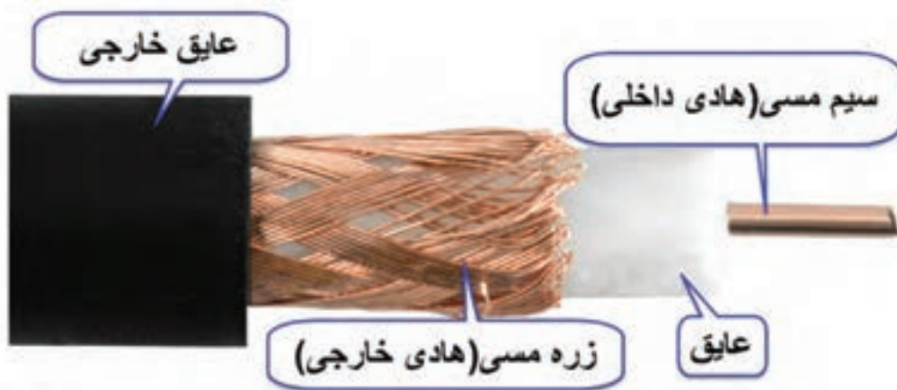
شکل ۴-۲- کابل کواکسیال و اجزای آن
