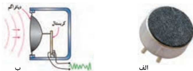
شکل ۱۶-۵- میکروفون کریستالی و ساختمان داخلی آن
