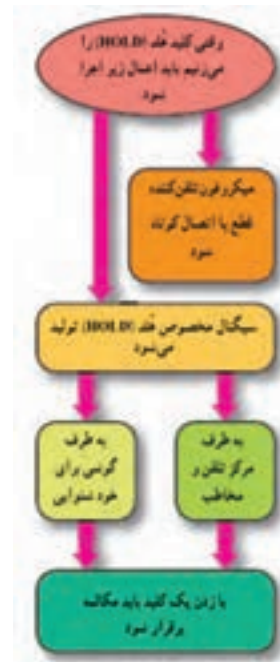
شکل ۳۲-۵- عملکرد مدار هلد
