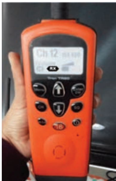
شکل ۳۷- دستگاه VHF در حالت دریافت (RX)
