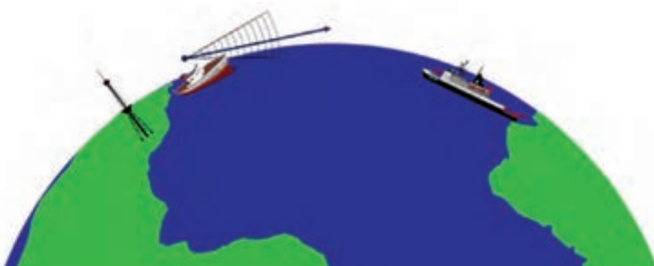
شکل ۷- انحناى زمین و ناتوانی آنتن‌های VHF در دیدن همدیگر
