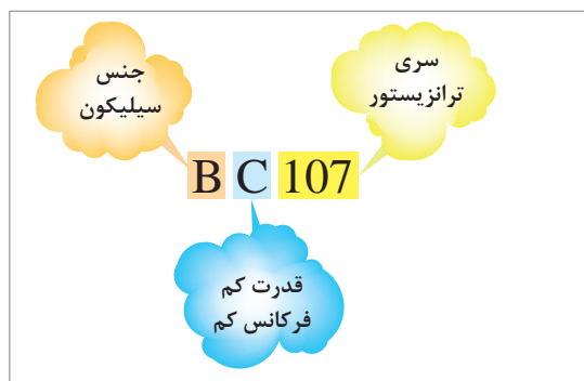
شکل ۲۳- مشخصات ظاهری ترانزیستور BC107
