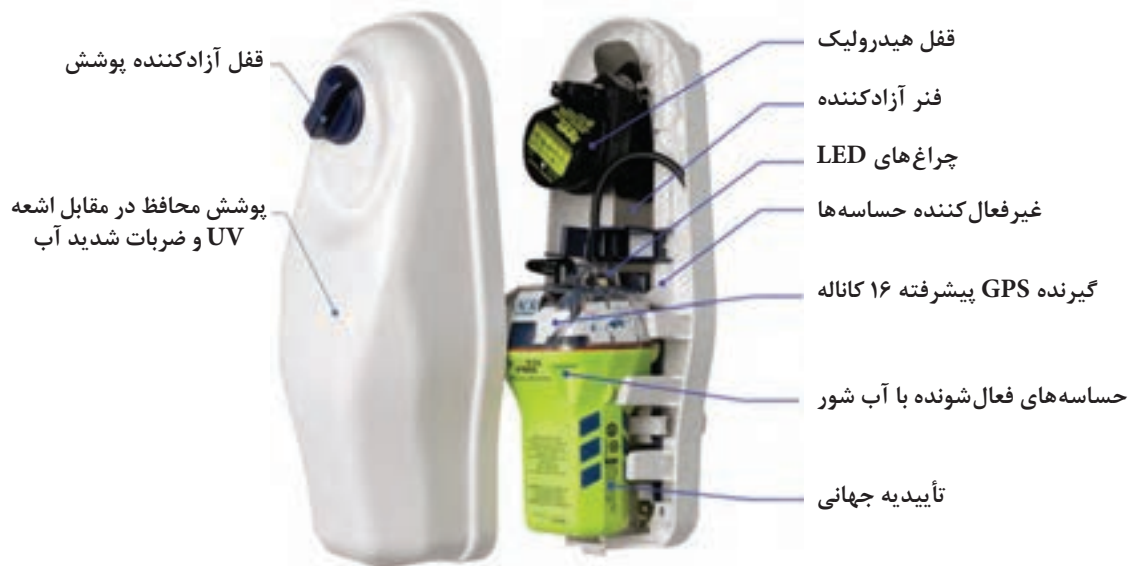
شکل ۱۱- اجزای تشکیل دهنده دستگاه EPIRB
