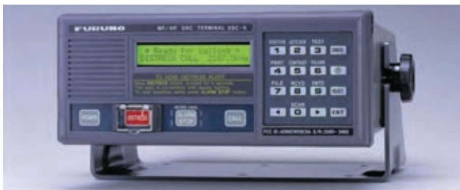
شکل ۲۴- نمونه رادیوی HF/MF مجهز به DSC
