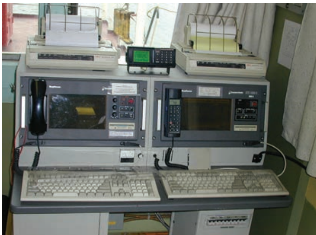
شکل ۷- دستگاه NAVTEX از تجهیزات GMDSS
