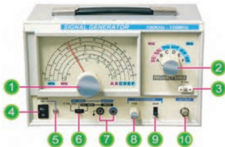
شکل ۱۸- شکل ظاهری دستگاه مولد RF و کنترل‌های آن
