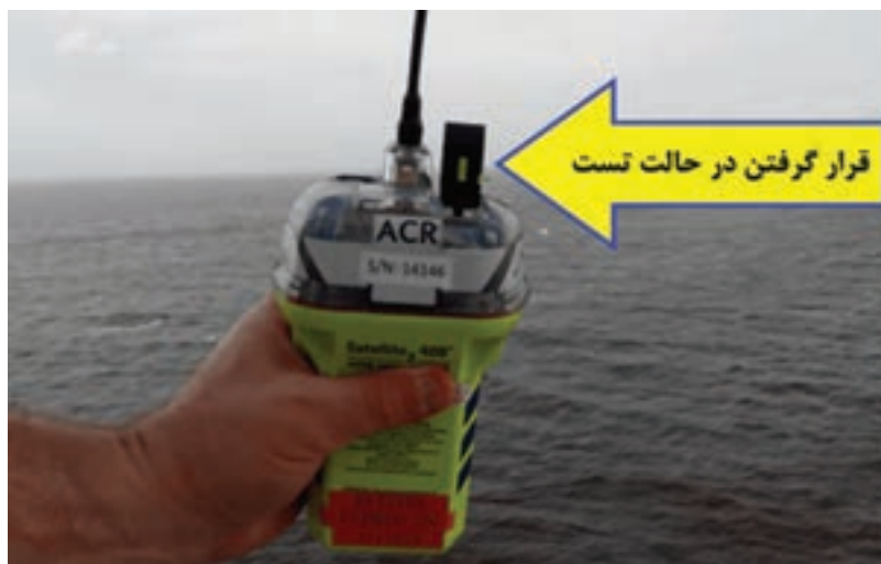
شکل ۳۷- قراردادن دستگاه EPIRB در حالت تست
