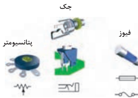
فیوز، جک گوشی، پتانسیومتر و شمای فنی آنها
