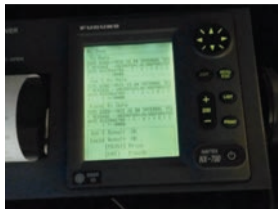
شکل ۴۴- آزمون دریافت کنندگی (RX) دستگاه NAVTEX
