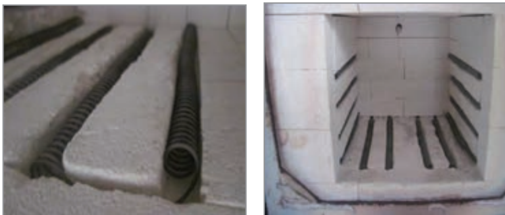
شکل ۱۳- نصب المنت درون شیار
