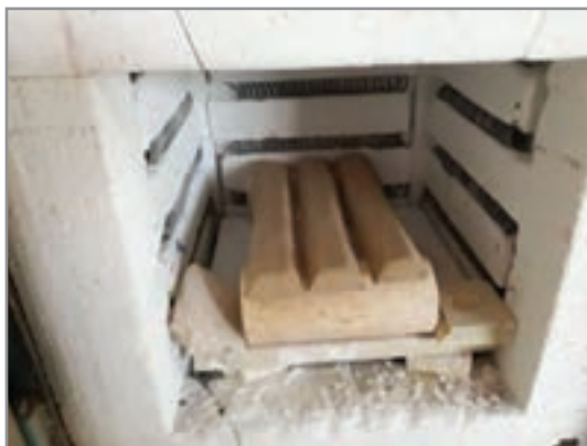
شکل ۳۴- قرار دادن نمونه‌های مقاومت به پخت در کوره
