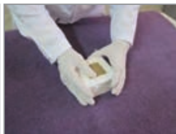
الف ب ج شکل ۷- ساخت نمونه انقباض و رسم قطرها
