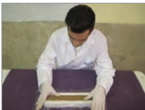
شکل ۳۲- ساخت نمونه‌های مقاومت به پخت
