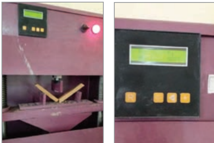
شکل ۲۴- اندازه‌گیری استحکام خمشی خشک نمونه‌ها
