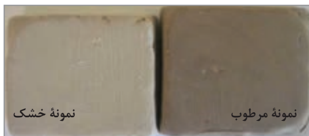
شکل ۲- تأثیر انقباض خشک در کاهش ابعاد نمونه
