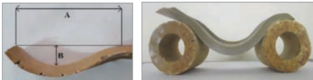
شکل ۳۶- اندازه‌گیری میزان انحنای نمونه مقاومت به پخت
