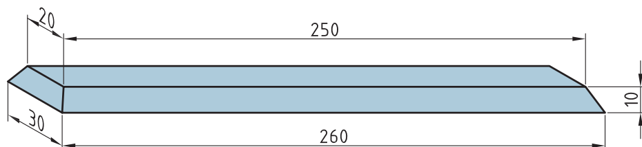
شکل ۳۱- ابعاد نمونه مقاومت به پخت
