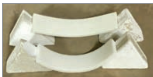
شکل ۳۰- آزمایش مقاومت پخت دو تکیه‌گاهی
