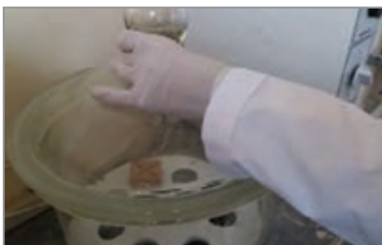
شکل ۱۰- انتقال نمونه‌های انقباض از خشک‌کن به دسیکاتور
