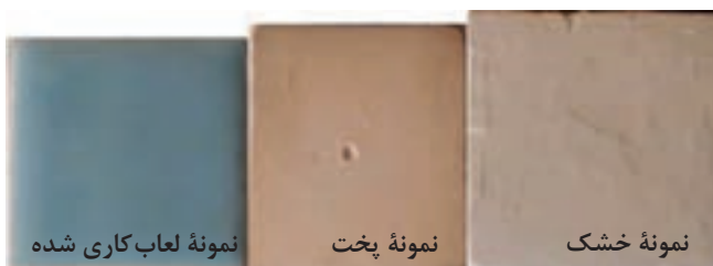
شکل ۱۲- تأثیر انقباض پخت بر ابعاد نمونه
