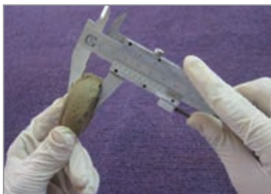
الف ب شکل ۶- بررسی ارتفاع ۱۶ میلی‌متر در آزمون ففرکورن
