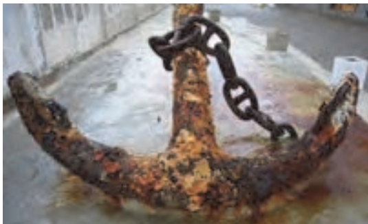
شکل ۳- نمونه‌هایی از خوردگی آب دریا
