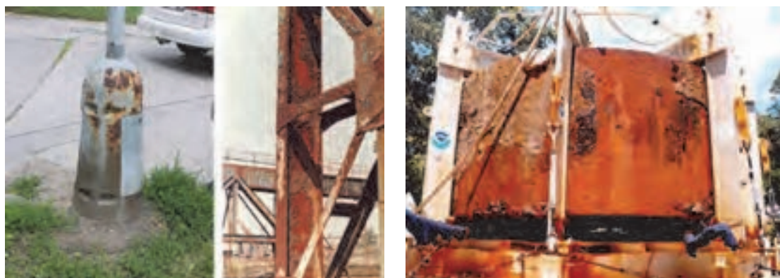
شکل ۵- نمونه‌هایی از خوردگی جوی
