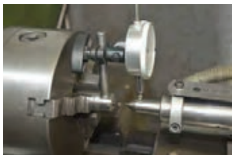
شکل ۲۸- اندازه‌گیری انحراف مرغک
