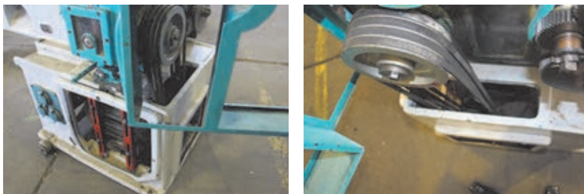
شکل ۳۷- اجزای انتقال حرکت از موتور به جعبه دنده اصلی
