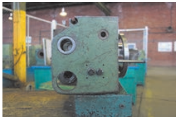
شکل ۲۰- پیچ تنظیم حساسیت اهرم‌های خودکار
