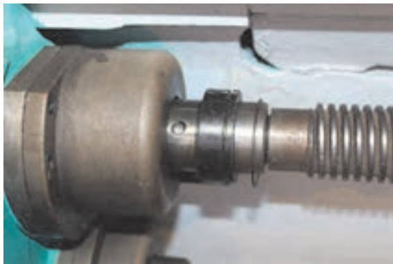
شکل ۳۶- پین فیوز مکانیکی همراه با حلقه محافظ
